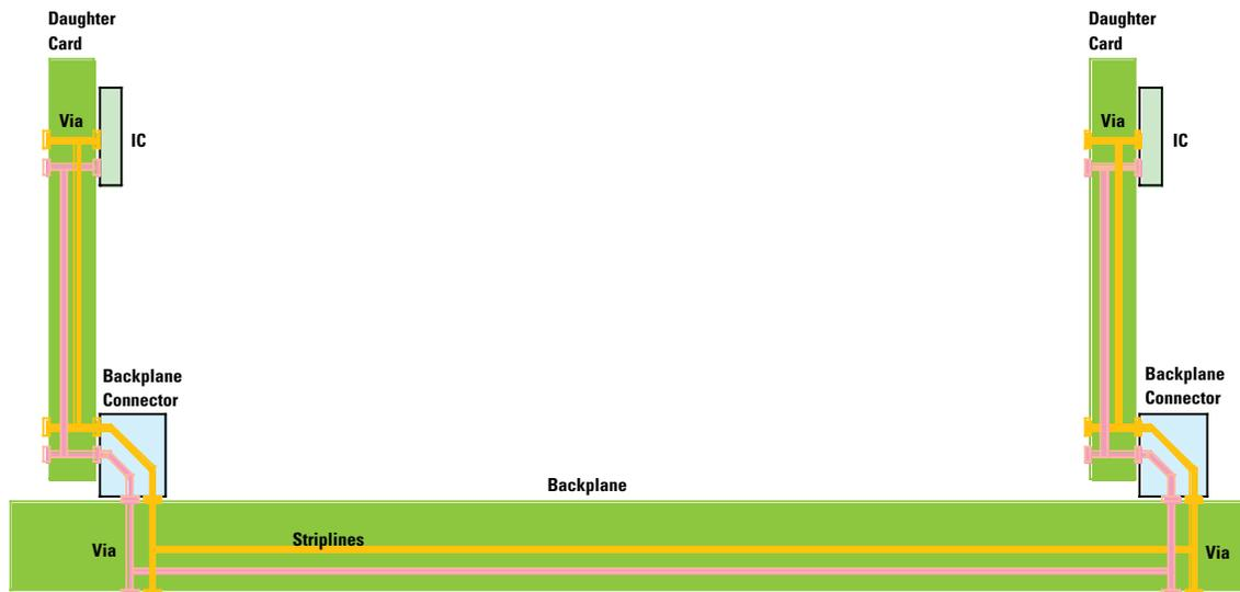
*Figure 5-5. A Simplified Backplane Subsystem*
