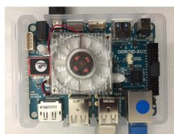
Figure 1. The ODRROID-XU3 Board
