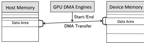
Fig. 3. Standard DMA.
