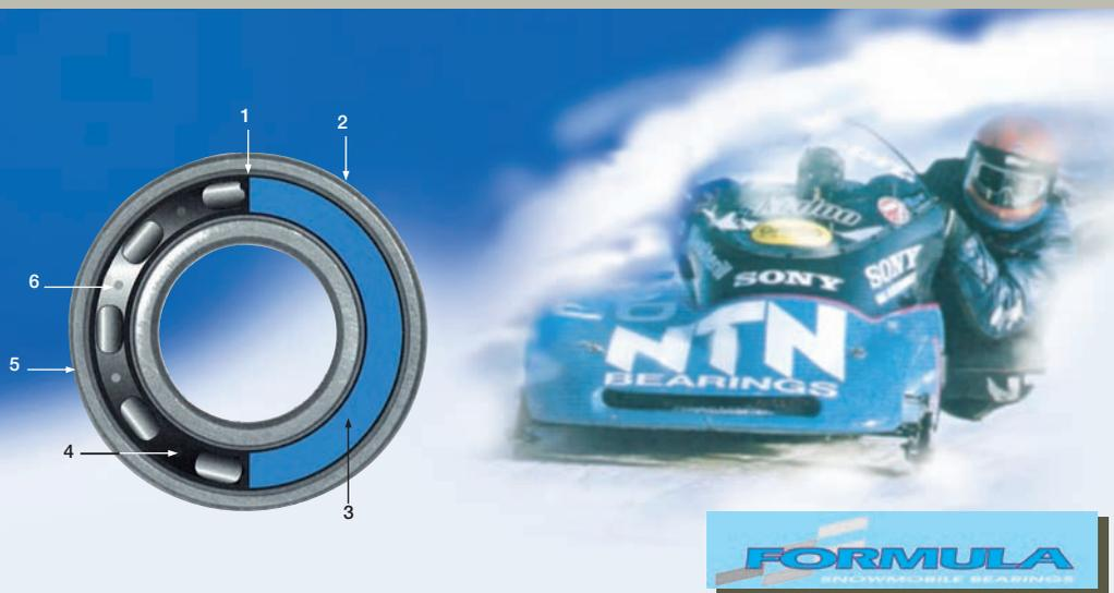
1 Superfinitura delle piste del cuscinetto - 2 Acciaio di alta qualità - 3 Tenuta a doppio labbro, con bassa coppia (colore blu - esclusiva NTN) - Armatura della tenuta rinforzata - 4 Grasso speciale per basse temperature, riempimento ottimale di grasso - 5 Assemblaggio ad alta precisione - 6 Gabbia in acciaio rivettato
