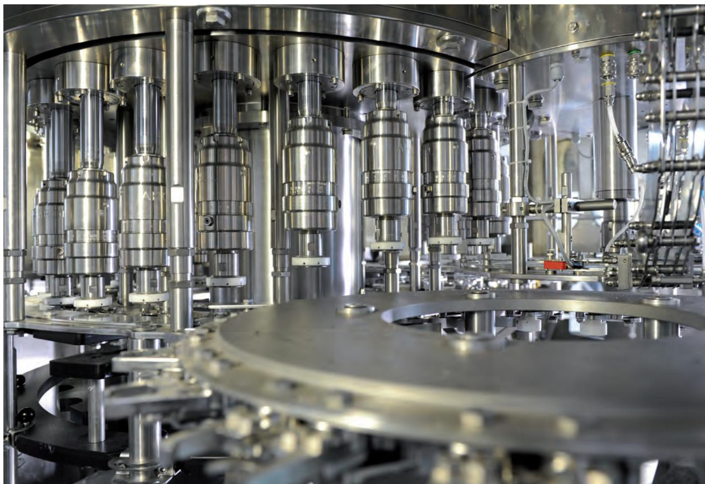
**IT** Il monoblocco può essere equipaggiato con tappatori per tappi a vite in plastica sia flat che sport, tappi a vite alluminio, tappi corona e tappi pressione. L'estrema flessibilità della soluzione permette di installare, su richiesta, anche due torrette di tappatura, soluzione particolarmente indicata in caso di sistema in grado di trattare sia bottiglie in VETRO che in PET.
