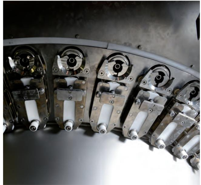
**IT** Le valvole di riempimento sono state concepite in modo tale da eliminare l'intervento e la discrezionalità dell'operatore. Tutte le fasi sono gestite via software attraverso ricette ottimizzate per ciascun tipo di prodotto. La tecnologia elettronica, sia volumetrica che a livello, permette la massima affidabilità nella precisione di riempimento e la garanzia di igiene durante il suo funzionamento.
