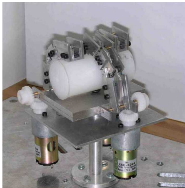
Fig. 2.21: Mano robotica LARM hand in presa su un oggetto cilindrico.
