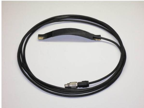
Figura A1.11 – Sensore di forza tipo omega.
