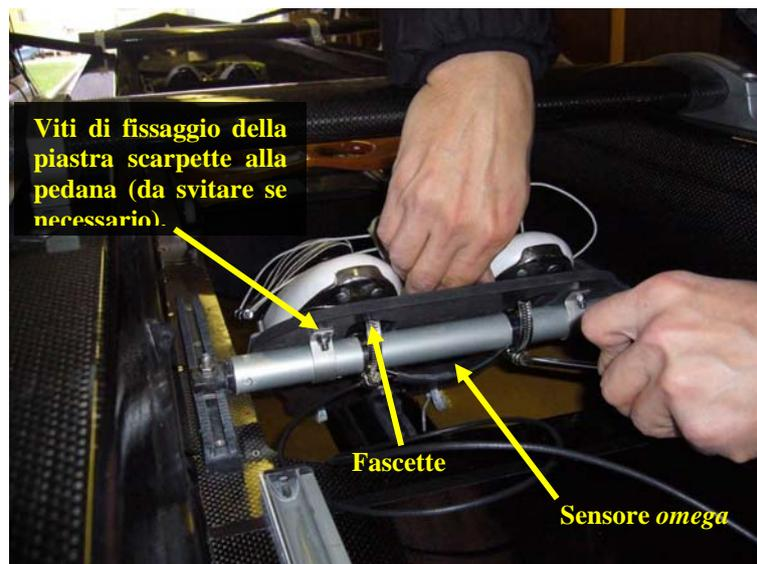
Figura A1.25 – Installazione del sensore di forza al puntapedali.
