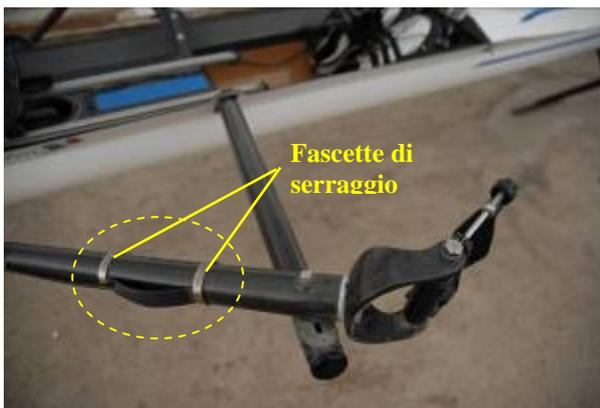
Figura 3.13. – Applicazione dell'OMEGA ad uno scalmi monotubo in carbonio.
