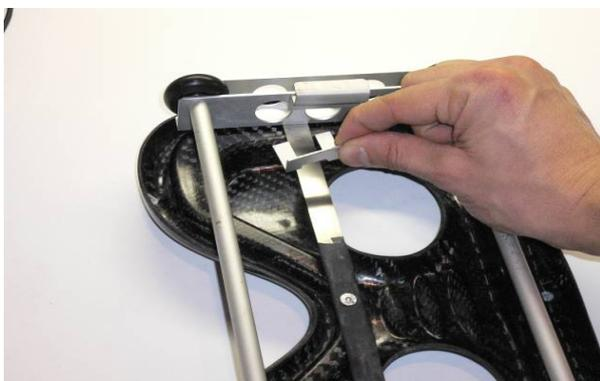
Figura A1.26 – Inserimento dell'accessorio per il sensore a lamina.
