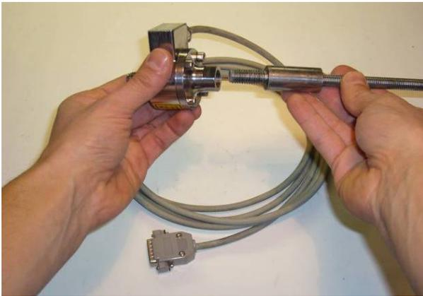
**Figura A1.64 – Montaggio attrezzatura di taratura per sensori di forza scalmi (fase 1).**
