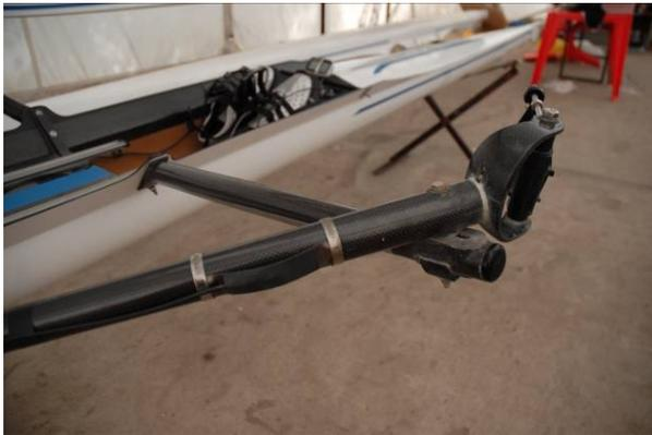
Figura A1.23 – Applicazione del sensore omega su braccio monotubo in carbonio.
