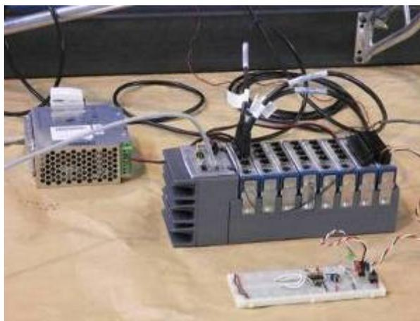
Figura 3.31 - Particolare della centralina (CompactRIO® della National Instruments®).
