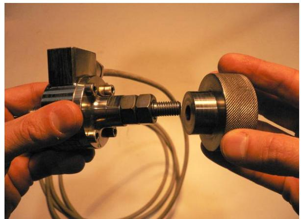
**Figura A1.68 – Montaggio attrezzatura per sensori di forza al puntapiedi (fase 2).**
