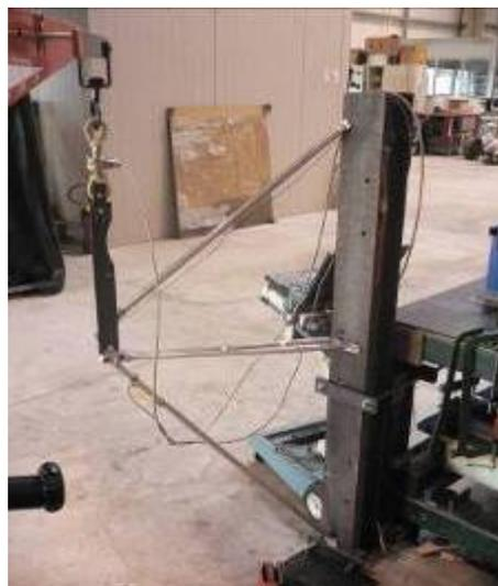
Figura 3.18 – Prove di sensibilità e linearità su braccio in alluminio.
