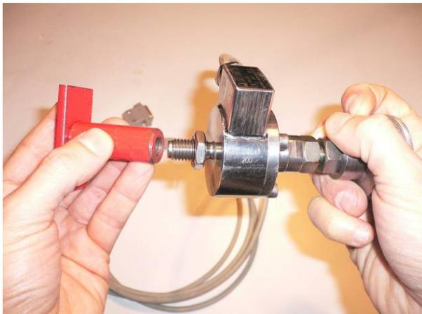
Figura A1.69 – Montaggio attrezzatura per sensori di forza al puntapiedi (fase 3).
