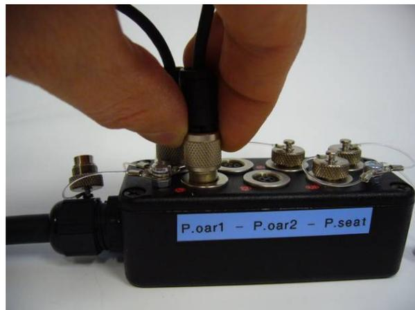
Figura A1.57 – Collegamento del sensore di posizione del remo 1 (esempio).
