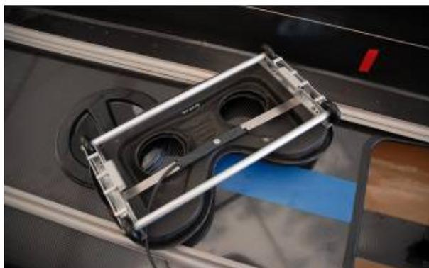
Figura 8.3 – Sensore di forza installato sul lato inferiore del sedile (carrello in alluminio).
