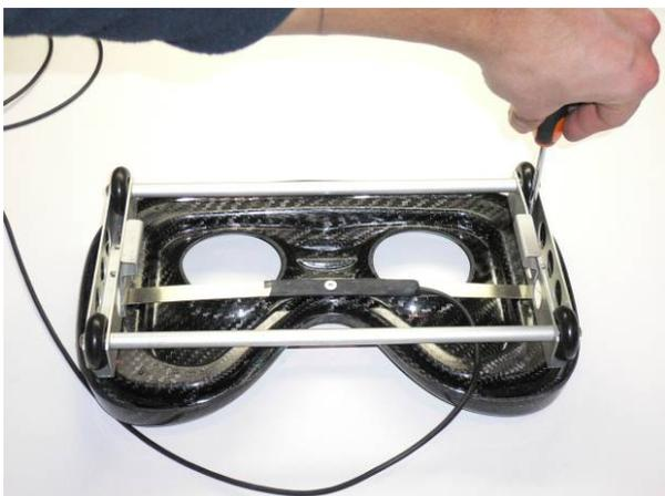
Figura A1.28 – Chiusura del sensore di forza.
