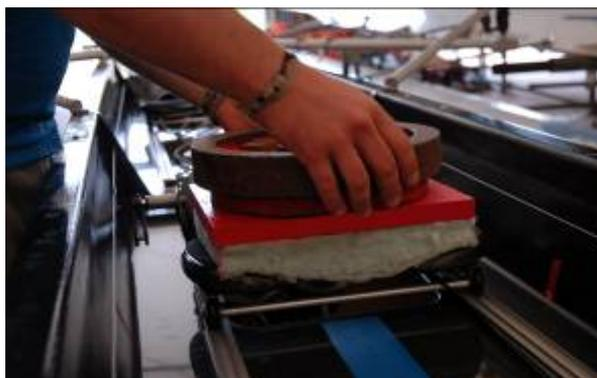
Figura 8.4 – Taratura del sensore di forza del seggiolino.
