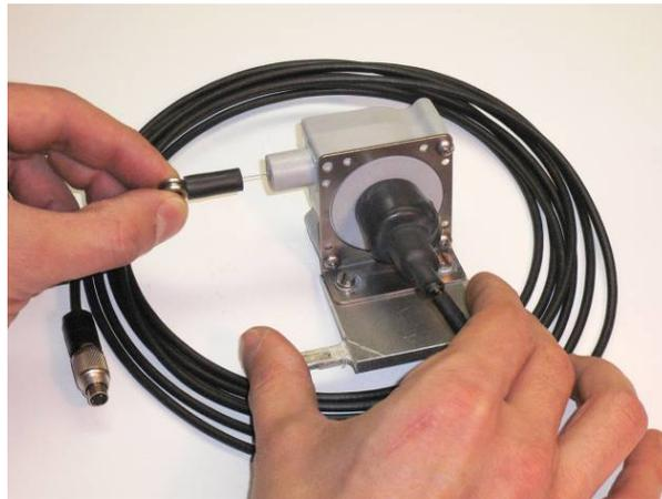
**Figura A1.13** – Sensore a filo per misura dellaposizione del seggiolino.
