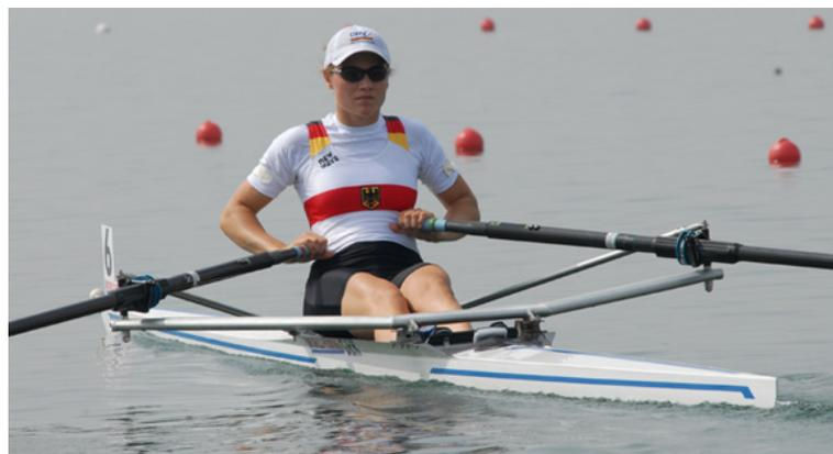
**Figura 7.1 – Esempio di imbarcazione singolo di coppia con braccio ad ala in alluminio.**
