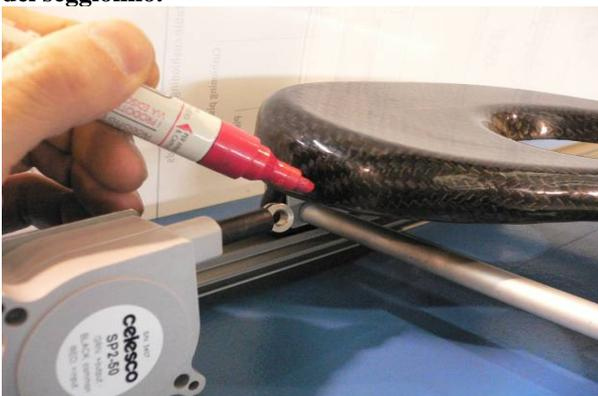
Figura A1.41 – Tracciatura del punto di arrivo del filo.
