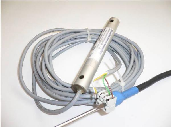
Figura A1.46 – Collegamento dell'accelerometro assiale al cavo C2.
