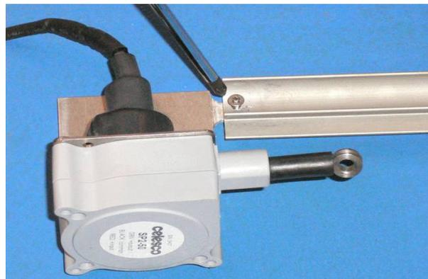
Figura A1.40 – Montaggio piastrina con sensore di posizione.
