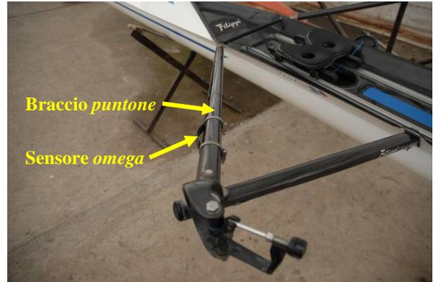
Figura A1.22 – Sensore ad installazione ultimata su braccio *monotubo*.
