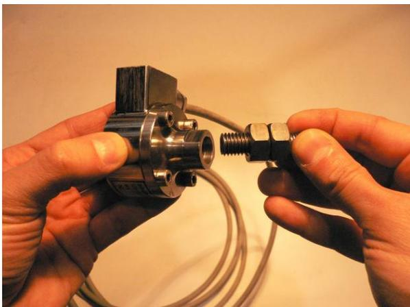
**Figura A1.67 – Montaggio attrezzatura per sensori di forza al puntapiedi (fase 1).**
