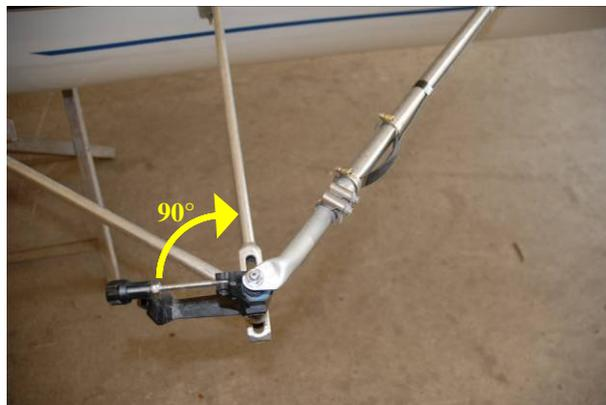
**Figura A1.80** – Azzeramento della posizione angolare dello scalmo (forcola parallela alla direzione della barca).
