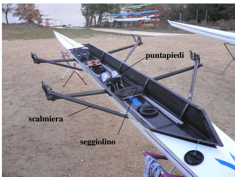
Figura 2.11 – Accessori principali di un'imbarcazione da canottaggio.
