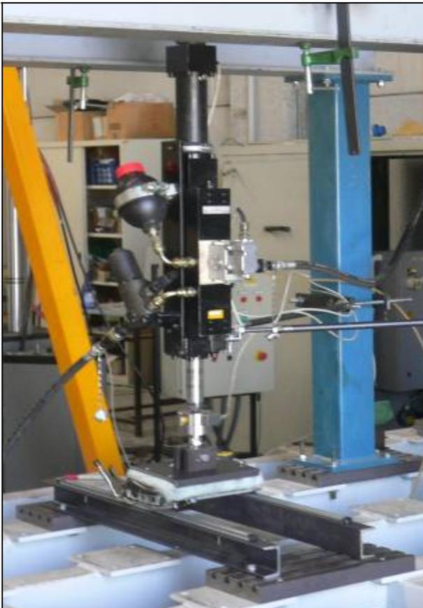
**Figura 8.6 - Prova di fatica in corso**
