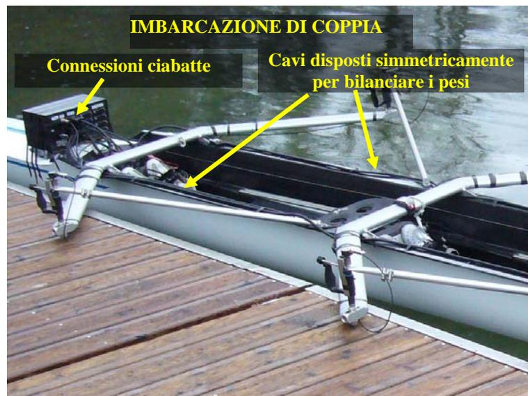
**Figura A1.55** – Disposizione cavi ciabatte e sensori ad installazione ultimata
