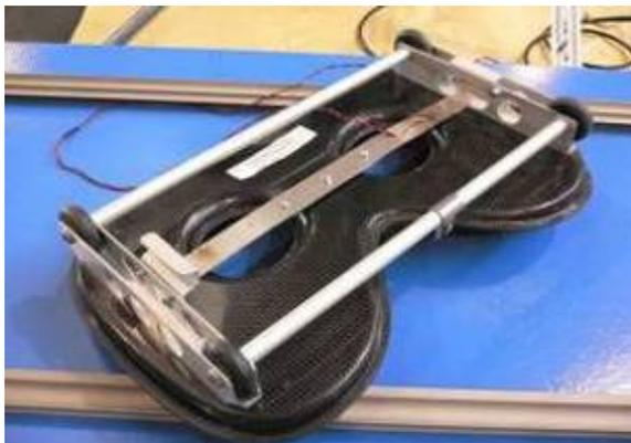
Figura 3.23 – Primo sviluppo del sensore di forza per seggiolino (seduta di tipo 1).
