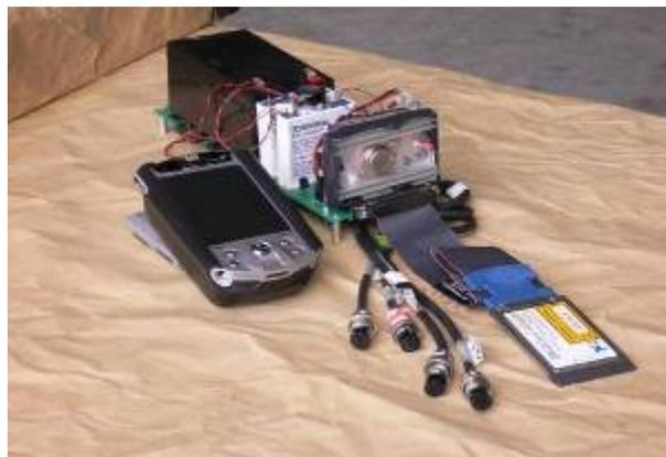
Figura 3.2 – Elettronica di condizionamento dei segnali, scheda di conversione analogico-digitale e computer palmare.
