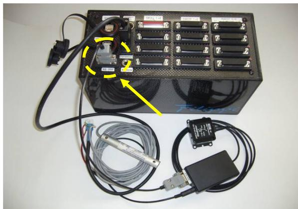
Figura A1.52 – Collegamento seriale della piattaforma inerziale al box di acquisizione.
