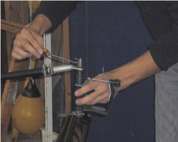
Figura A1.31 – Montaggio del giunto cilindrico potenziometro.
