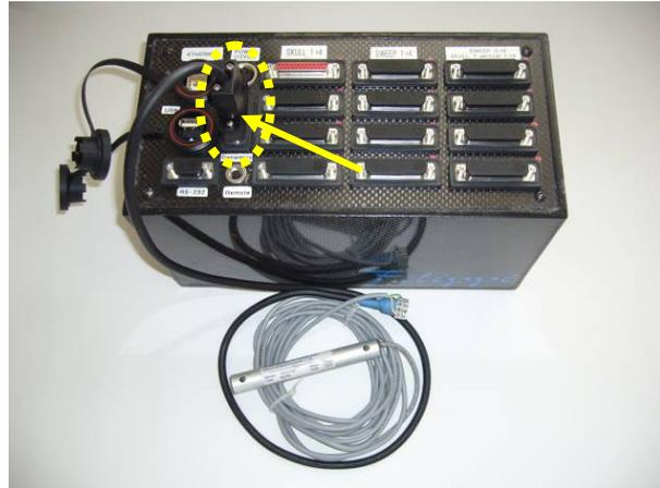
Figura A1.47 – Collegamento del cavo C2 al box di acquisizione.
