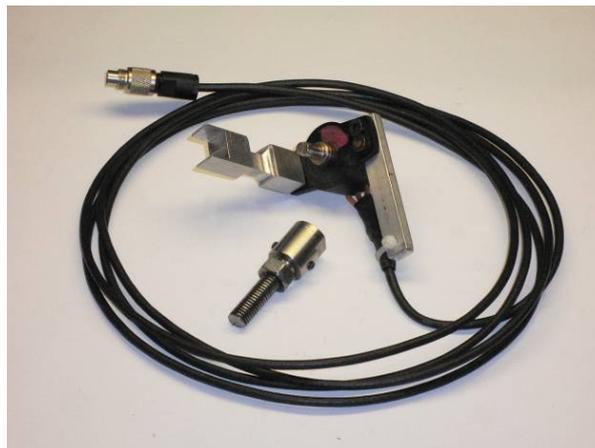
Figura A1.16 – Kit 2 posizione remo: sensore di rotazione scalmi con accessori per scalmiere monotubo in carbonio.
