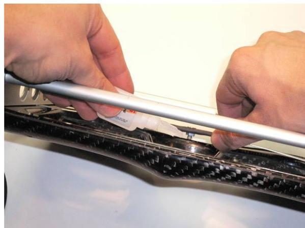
Figura A1.29 – Incollaggio della vite centrale.
