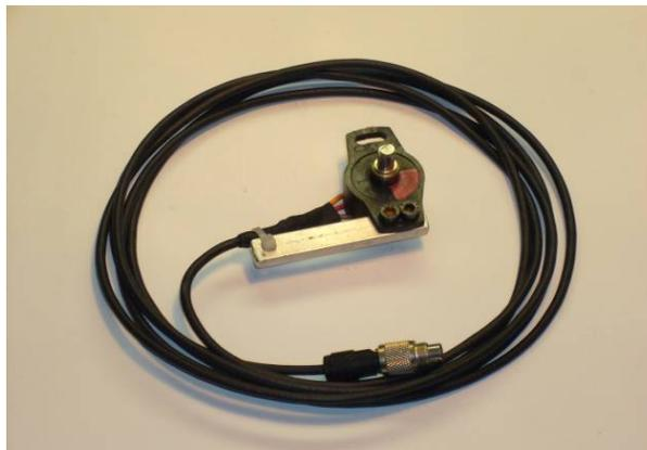
**Figura A1.14** – Potenziometro rotativo per la misura di rotazione scalmi.
