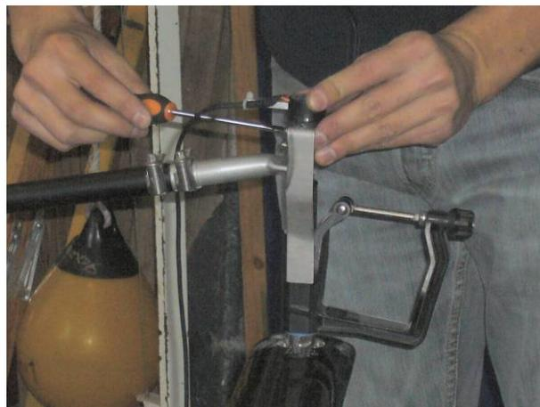
Figura A1.33 – Montaggio del potenziometro.
