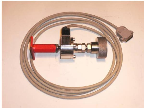
Figura A1.70 – Montaggio attrezzatura per sensori di forza al puntapiedi (fase 4).
