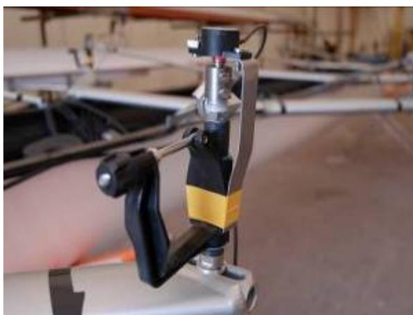
Figura 3.28 – Sensore di posizione dello scalmo per bracci in alluminio.
