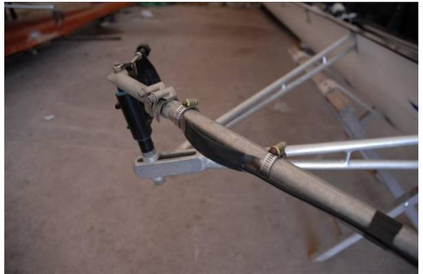
Figura A1.24 – Applicazione del sensore omega su bracci a traliccio in alluminio (fissaggio sul 5° braccio).
