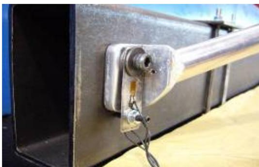
Figura 3.7 – Particolare su banco prova del sensore di forza a lamina (flangia di attacco di un braccio in alluminio).
