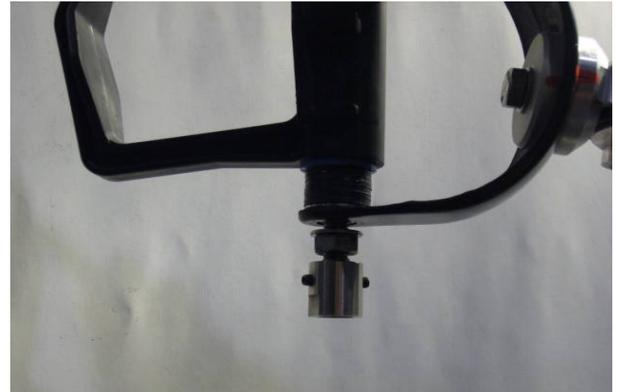
Figura A1.35 – Avvitare l'accessorio cilindrico.
