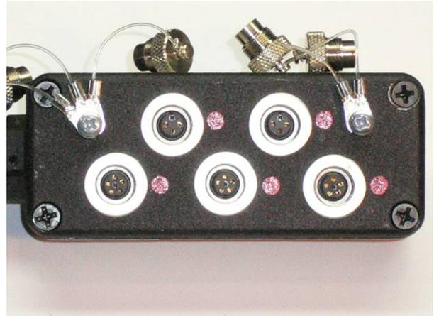
Figura A1.7 – Connettori scatola per barche “di punta”: i cinque poli sono per sensori di forza, mentre quelli a tre per i sensori di posizione.
