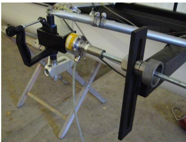
Figura 7.7 – Particolare della cella di carico.
