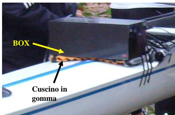
Figura A1.53 – Esempio di sistemazione del box di acquisizione (scatola con connettori in orizzontale verso prua).
