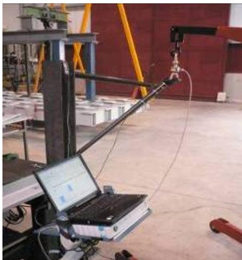
Figura 3.17 – Prove di sensibilità e linearità del sensore su braccio monotubo in carbonio.
