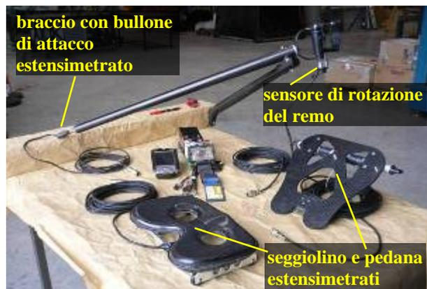
Figura 3.1 – Primo sviluppo di un sistema di acquisizione imbarcabile.
