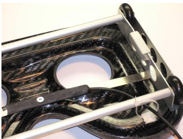
Figura A1.30 – Sistemazione del cavo con fascetta.
