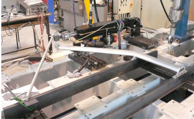
Figura 7.14 – Istantanea della prova su un braccio di punta.
