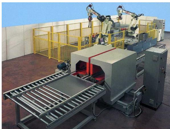
(a) Esempio di rulleria con formazione della lamiera prima dell'isola di puntatura di armadi per spogliatoio (TSR).
