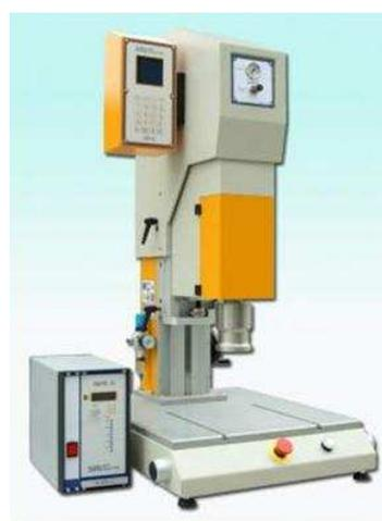
(b) Saldatrice ad ultrasuoni.
