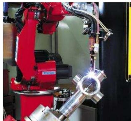
(b) Manipolazione e saldatura di raccordi in acciaio inox con carico e scarico automatico mediante combinazione di torcia e pinza.
