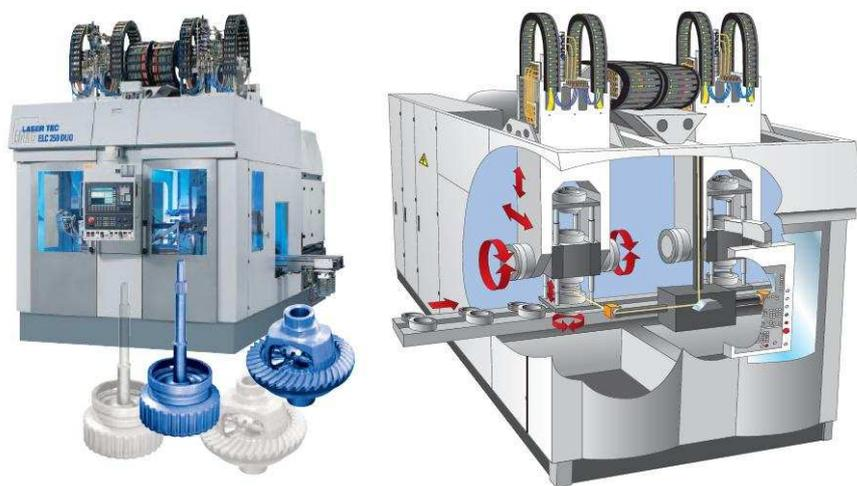
Figura 3.9: Impianto di saldatura al fascio laser.
