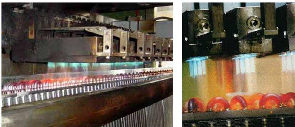
Figura 4.6: Esempi di bruciatori per brasatura automatica di batterie alettate.
