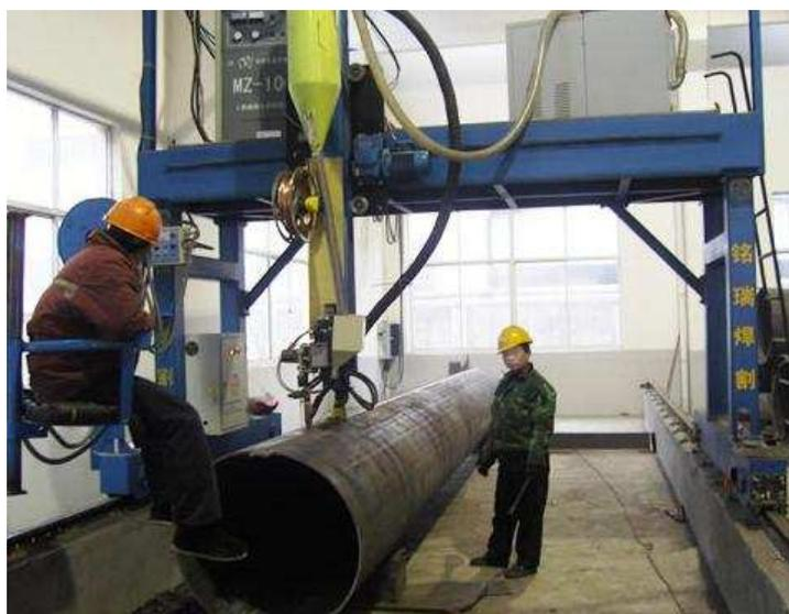
Figura 2.16: Macchina automatica per saldatura ad arco sommerso.
