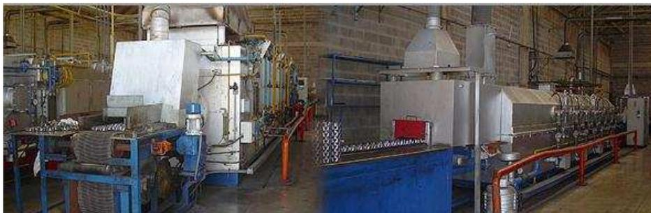
Figura 2.52: Forno per brasature e saldabrasature che opera fino a 1150°C con atmosfera controllata.
