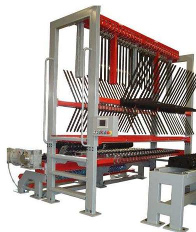
(b) Traino fili longitudinali per il controllo ed allineamento dei fili longitudinali utilizzato nell'impianto per reti elettrosaldate (pagina 80, 4).
