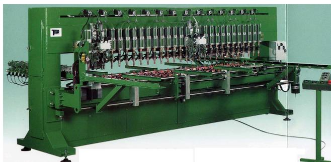
(b) Impianto a teste multiple in linea per saldatura di a punti di pannelli in lamiera (TRS).
