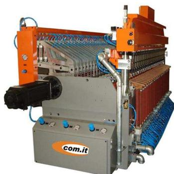
(a) Saldatrice a resistenza per la produzione di griglie elettrosaldate (particolare 7 dell'esempio proposto).
