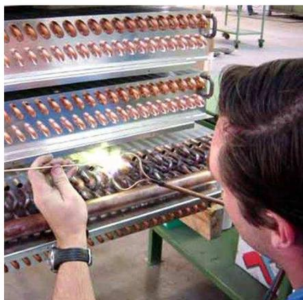
(a) Esempio di brasatura delle curvette con lancia biforcuta.
