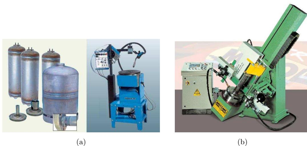
Figura 3.7: Postazioni di saldatura ad arco fisse.
