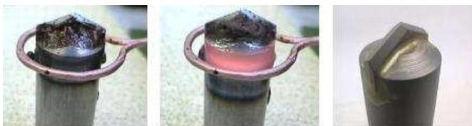
Figura 2.53: Brasatura ad induzione utilizzando una pasta con flusso protettivo.
