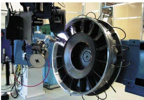
(a) Componenti per turbine di aerei con 10 assi interpolati.
