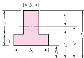
$$r_c = r_i + \frac{b_i c_1^2 + 2b_o c_1 c_2 + b_o c_2^2}{2(b_o c_2 + b_i c_1)}$$
