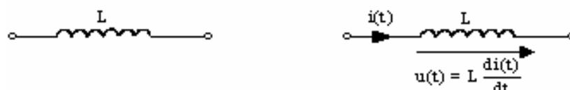
Figur 29: Induktivität mit Verbraucherpfeilsystem.
