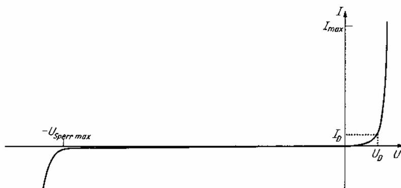
Figur 55: Kennlinie einer Halbleiterdiode mit den charakteristischen Grössen: Maximale Sperrspannung  $U_{\text{sperr max}}$ , maximaler Durchlassstrom  $I_{\text{max}}$  und Durchlassspannung  $U_D$  bei  $I_D = I_{\text{max}}/10$ .
