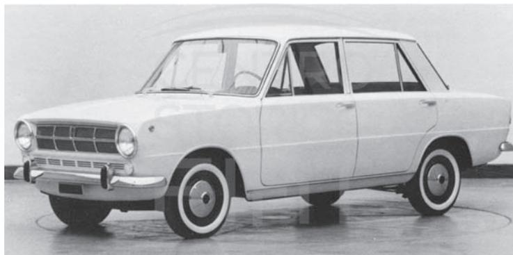
Prototipo 124/540 con carrozzeria in materia plastica (soluzione 1a, 1963).
