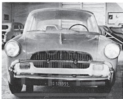
*Due viste di un modello in gesso in grandezza naturale: è un perfezionamento del precedente tipo 111, ancora legato a un impianto formale sostanzialmente curvilineo. La vettura, che non fu prodotta, avrebbe avuto una grande somiglianza con i tipi realizzati dalla Simca. Anche in questo caso la finta targa adombra l'anno di realizzazione dello studio: il 1955 (30 luglio).*
