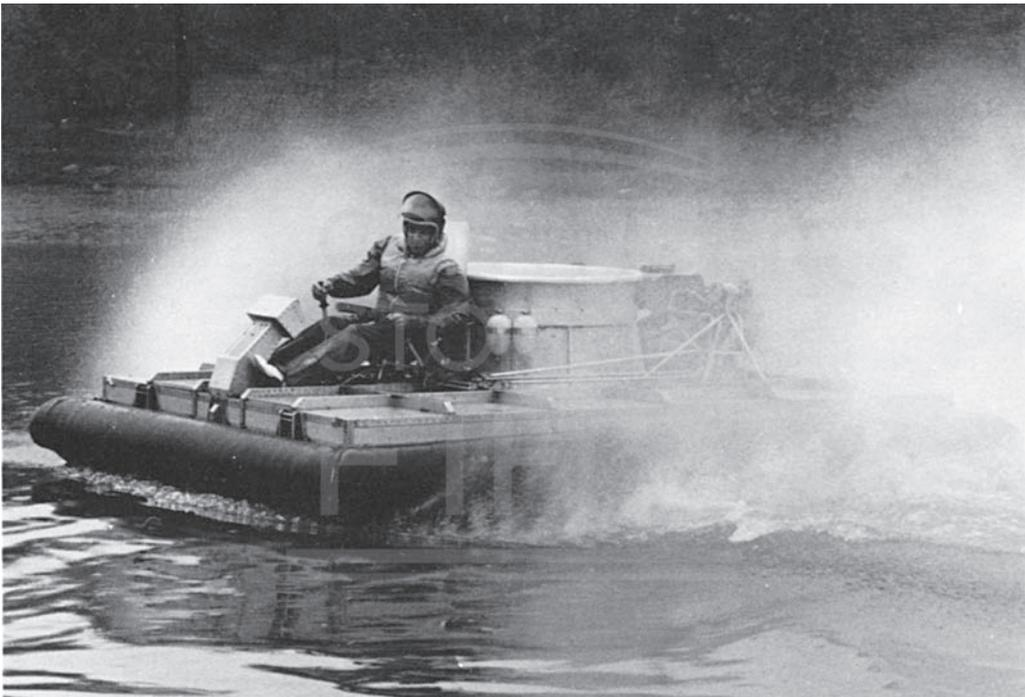
La piattaforma sperimentale con motore a turbina in prova sull'acqua. Alla guida il progettista, ingegnere Luciano Scholz (1964).
