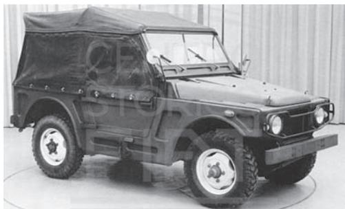
Il tipo 08 era una versione a carrozzeria portante della Campagnola, di cui utilizzava i gruppi meccanici. Il motore, la sospensione anteriore e la trasmissione alle ruote anteriori erano sopportati da un telarino fissato alla carrozzeria con pochi bulloni. Fu costruito nel 1960 sotto la direzione dell'ingegner Puleo.
