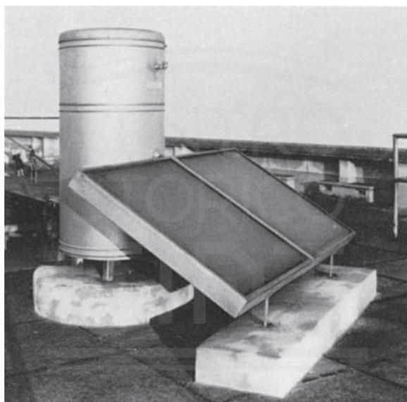
Apparecchio sperimentale per il riscaldamento dell'acqua con pannelli solari.
