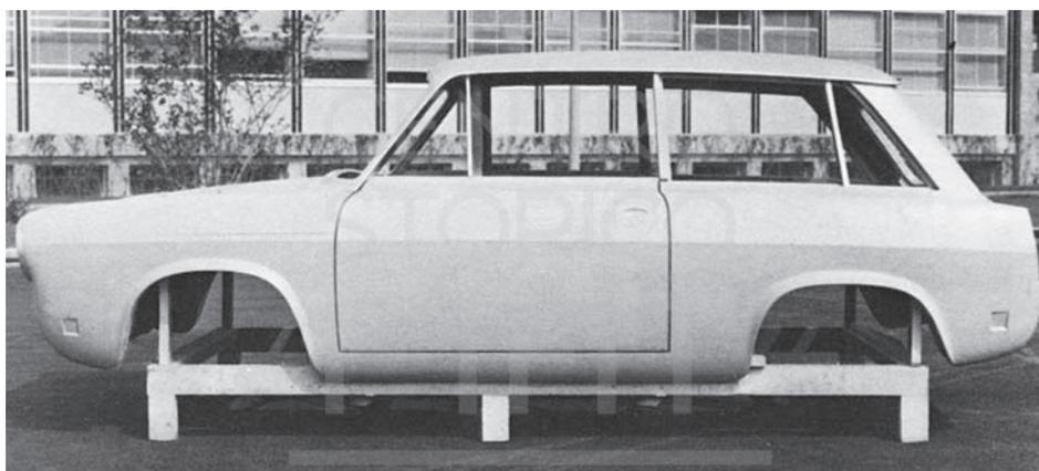
*Il modello in gesso della seconda soluzione per la vettura tipo 09, presentato nel 1961 nel giardino del Centro stile.*
