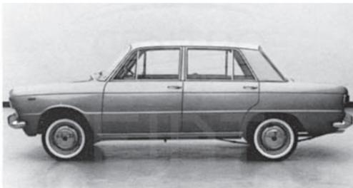
La vettura tipo G. 123 E4 a trazione anteriore impiegava il motore 103 collocato trasversalmente (come avverrà poi per la Primula) e la carrozzeria era particolarmente "ortodossa". Con questa soluzione l'Autore sperava di indurre la presidenza a deliberare la produzione della prima Fiat a trazione anteriore.
