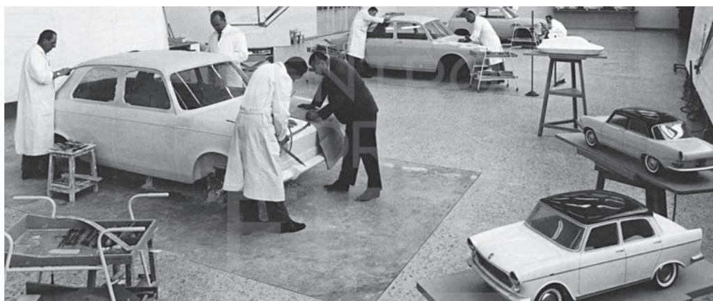
Una delle grandi sale per la costruzione di modelli in gesso al Centro stile di via La Manta (1962). In primo piano uno dei modelli in scala 1:5 elaborati durante l'impostazione stilistica della 1300-1500: sono ancora evidenti le influenze della 1800 nel trattamento del padiglione e nell'andamento spigoloso della fiancata.
