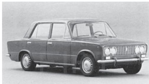
La 124 Special, presentata il 6 ottobre 1968, aveva un motore maggiorato da 197 a 1.438 cm<sup>3</sup>, capace di erogare 70 CV DIN.
