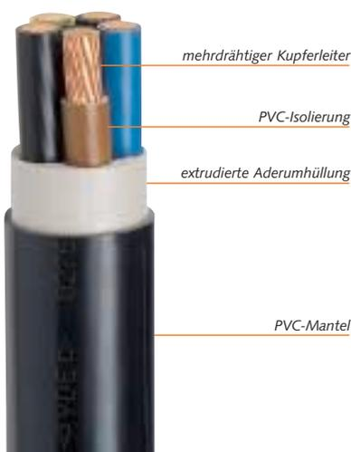
Bild 16: 1 kV-Starkstromkabel
