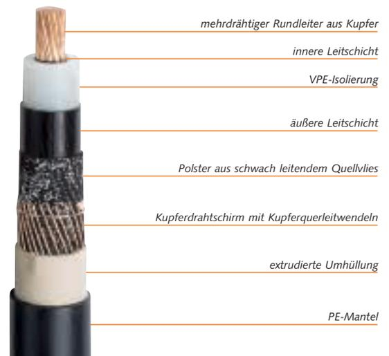
**Bild 18: 20 kV-VPE-Kabel längswasserdicht**
