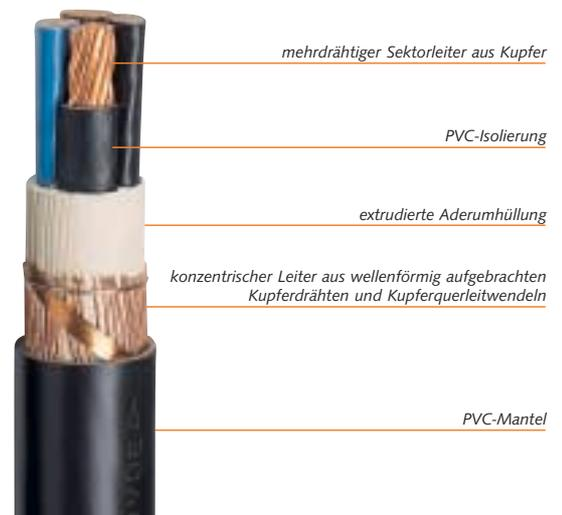
**Bild 17: 1 kV-Starkstromkabel mit konzentriertem Leiter**
