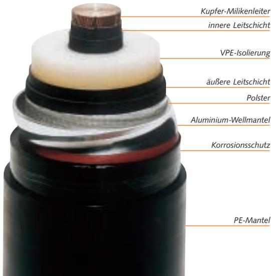
Bild 20: 400 kV-VPE-Kabel
