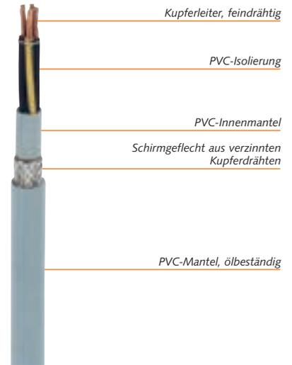
Bild 29: PVC-Steuerleitung geschirmt
