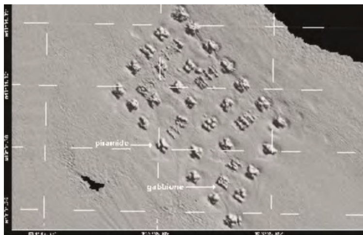
Fig. 7 - Immagine multibeam di una delle tre oasi che costituiscono la barriera artificiale a fini multipli realizzata nella baia di Portonovo (Adriatico centro-settentrionale) da una cooperativa locale di pescatori. Foto di CNR-IRPEM.
