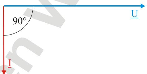
Bild 4.3.2-4: Zeigerdiagramm Induktivität
