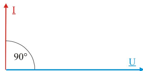
Bild 4.3.3-4: Zeigerdiagramm Kapazität
