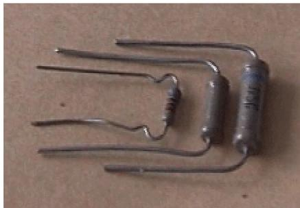
Widerstand (R) und Leitwert **Der Leitwert ist der Kehrwert des Widerstandes in  $\Omega$  (Ohm) und**
