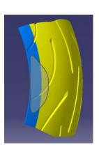
Abbildung 1: Kontaktfläche (Latsch) eines Motorradreifens bei 0°, 36° und 48° Schräglage /1/
