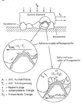
Abbildung 3: Schematische Darstellung der Adhäsions- und Deformationsreibkraftkomponente /2/
