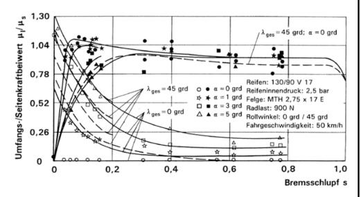
Abbildung 4: Kraftschluss eines Reifens bei unterschiedlichen Schräglagen (Rollwinkel λ) und Schräglaufwinkeln (Lenkeinschlag α) in Abhängigkeit vom Bremsschlupf /5/
