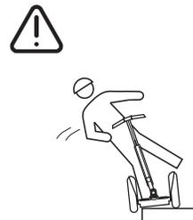
**Schéma 36 : ne pas laisser une roue butter contre une bordure de trottoir**
