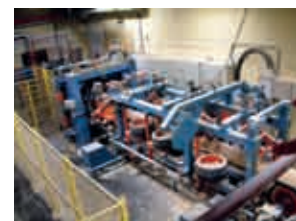
Här har stocken kommit in i sågverket. Den kommer att delas flera gånger. Hur många brädor det blir till varje stock beror på hur tjocka brädor man gör och hur tjock stocken är. Sågspånet som blir när man sågar isär stocken används som bränsle eller för tillverkning av spånskivor.
