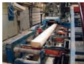
Här har stocken kommit in i sågverket. Den kommer att delas flera gånger. Hur många brädor det blir till varje stock beror på hur tjocka brädor man gör och hur tjock stocken är. Sågspånet som blir när man sågar isär stocken används som bränsle eller för tillverkning av spånskivor.
