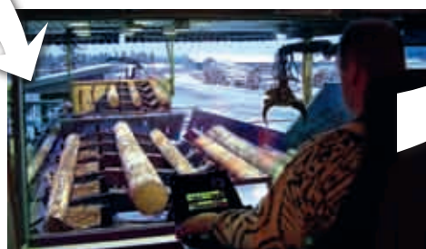
I mätstationen mäts stockarnas längd, tjocklek och kvalitet.
