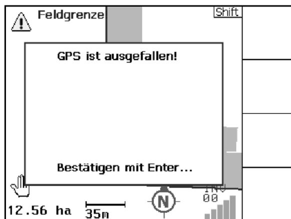
Identifiziert der GPS-Switch ein Signal als Ausreißer, so wird dieses im Display angezeigt.
