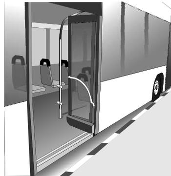
Figura 123. Bus de piso bajo. Barras para apoyo en colores contrastantes.
