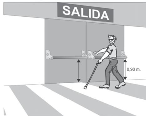
Figura 64. Mecanismo de presión en puerta de emergencia
