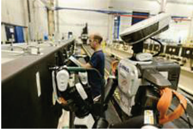
FIGURE 1.6. – Un robot collaboratif sur les chaînes d’assemblage Airbus.
