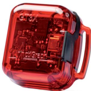
*Figura 3. Acelerómetro ActiGraph para cuantificar la actividad física.*
