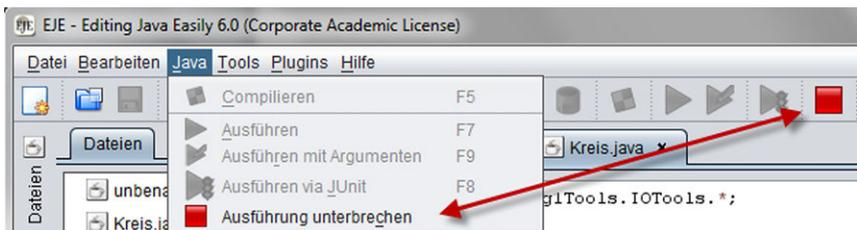
Abb. 5.12: Java-Programm in der Ausführung unterbrechen
