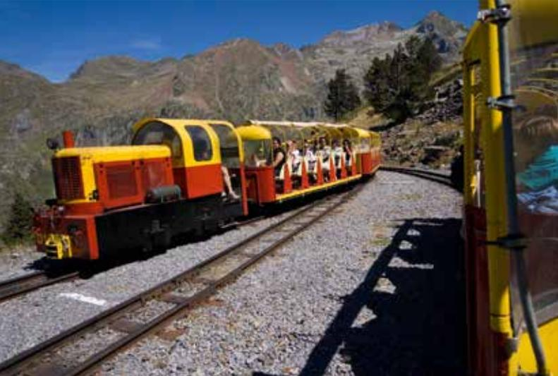
Imaginé et implanté lors de la construction des aménagements en vallée d'Ossau, via la SHEM, filiale d'ENGIE, le train d'Artouste a permis l'acheminement des hommes et des matériaux nécessaires au chantier à plus de 1600 m d'altitude. Longue de 9 km à flanc de montagne, la voie ferrée est toujours en exploitation aujourd'hui mais permet de concilier plusieurs usages. En effet, si son origine est industrielle, l'activité principale actuelle de cette installation est le tourisme.
