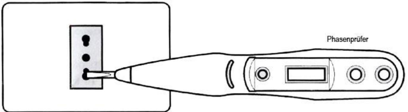
Unter Verwendung des Phasenprüfers, die in Ihrer Power Unit enthalten ist, ermitteln Sie die Stromführende Phase ("Hot" oder "Live"). Der Stecker, in dem der Phasenprüfer eingesteckt und eingeschaltet wird, leuchtet mit einem dauerhaft oder blinkendem Licht, viel schneller als der andere Stecker, wo sich der Stromführende Draht (Phase) befindet.
