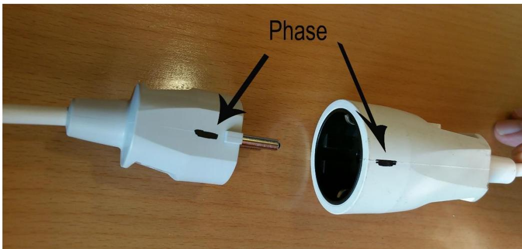
Wenn die Magrav Power Unit falsch an den "Neutralen" Draht, anstelle vom Phasendraht ("Live") verbunden wird, gibt es eine sehr hohe Wahrscheinlichkeit, dass die Einheit außer Betrieb gesetzt und somit nicht in den Anwendungsbereich der Herstellergarantie fällt.
