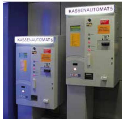
Kassenautomat in niedriger Bauweise zur einfachen Bedienung für Rollstuhlfahrer
