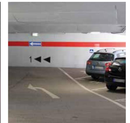
Fahrgasse mit deutlicher Richtungsführung durch Boden- und Wandmarkierung sowie StVO Verkehrszeichen
