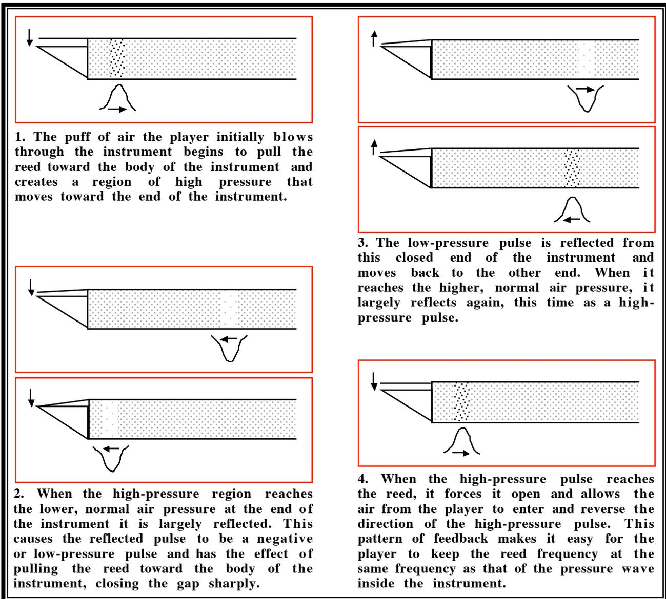
FIGURE 6.3: VIBRATION MECHANISM FOR THE MECHANICAL REED/TUBE SYSTEM
