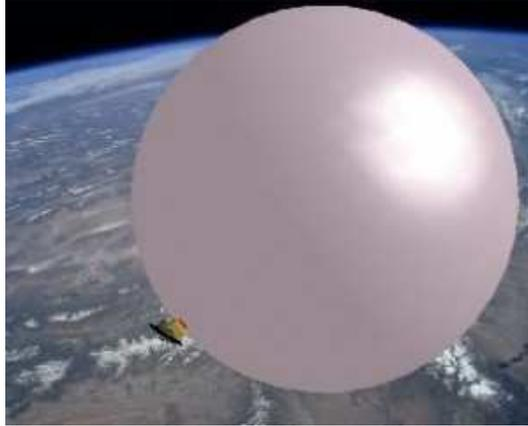
Figure 13. GOLD Drag Brake Concept<sup>14</sup>
