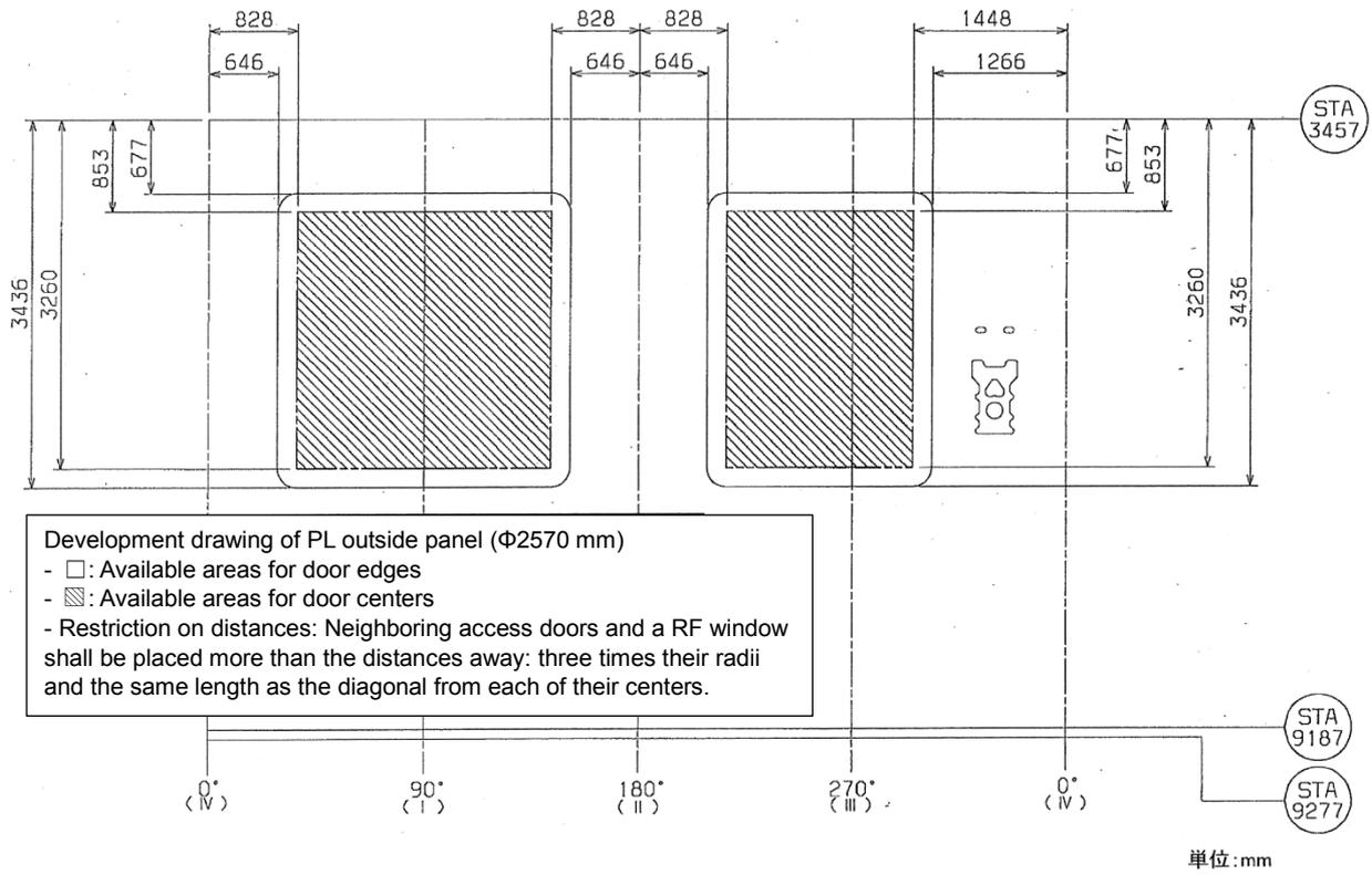
Figure 4.1.2-4 Access door ( $\Phi 350$  mm)
