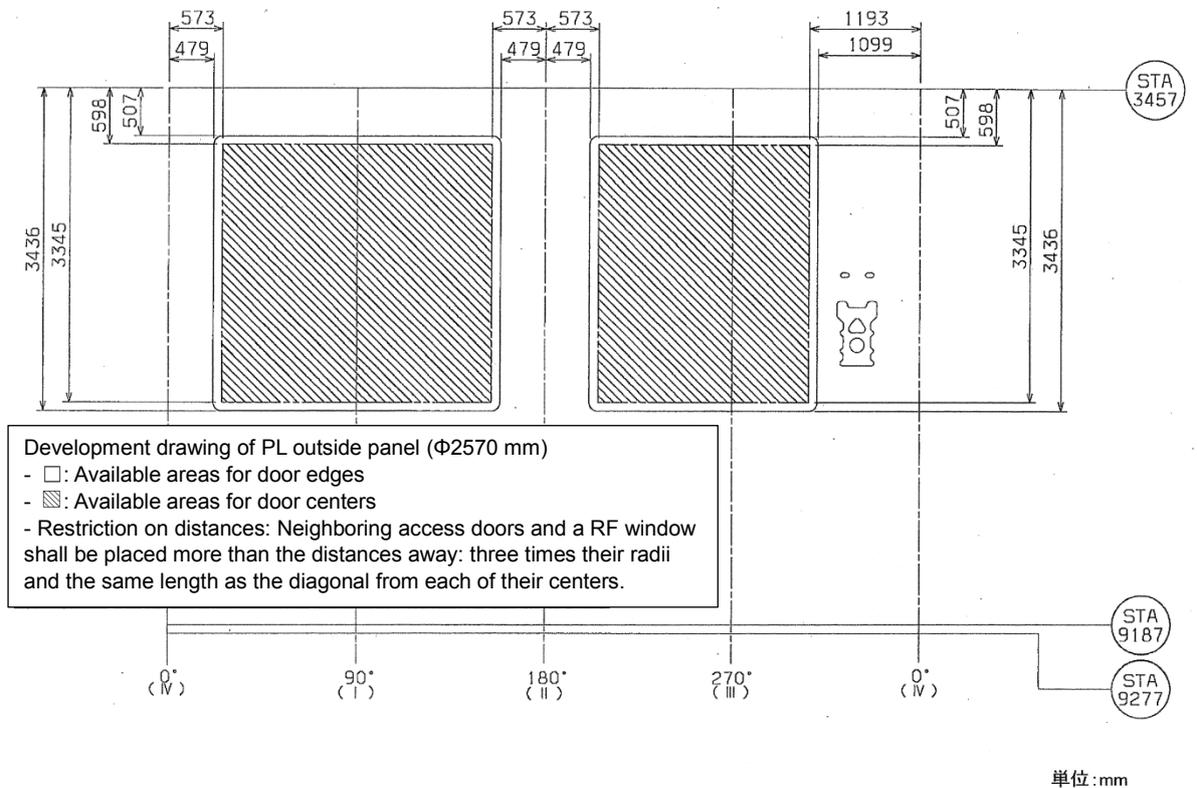
Figure 4.1.2-3 Access door ( $\Phi 180$  mm)
