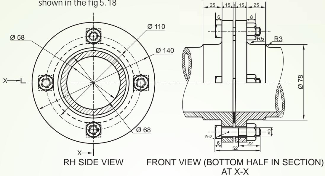
**ASSEMBLY OF A FLANGED PIPE JOINT**
