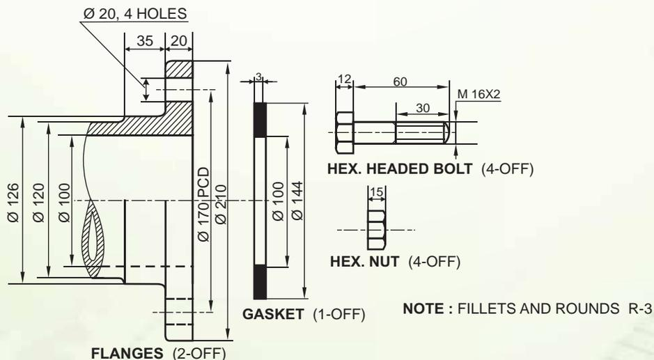
**DETAILS OF A FLANGED PIPE JOINT**
