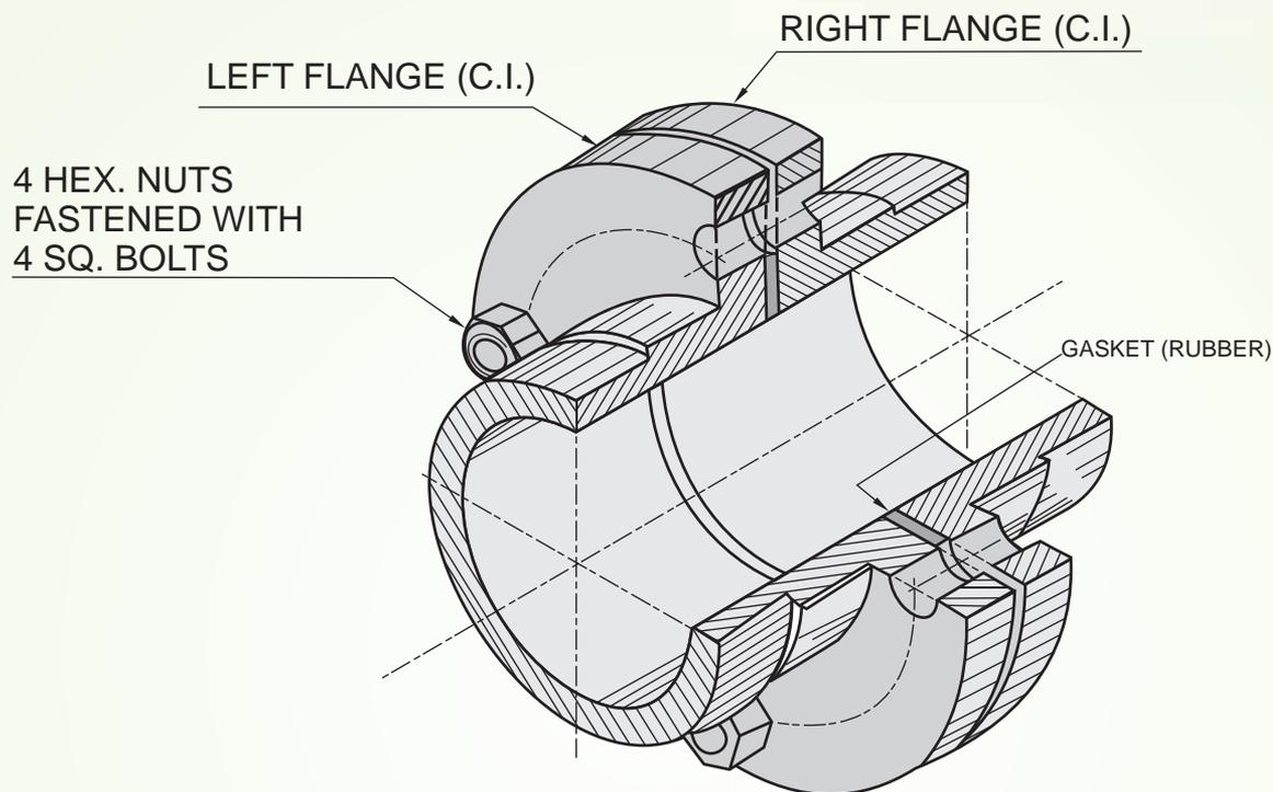
ASSEMBLY OF CAST - IRON FLANGED JOINT
