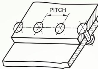
**SINGLE RIVETED LAP JOINT.**
