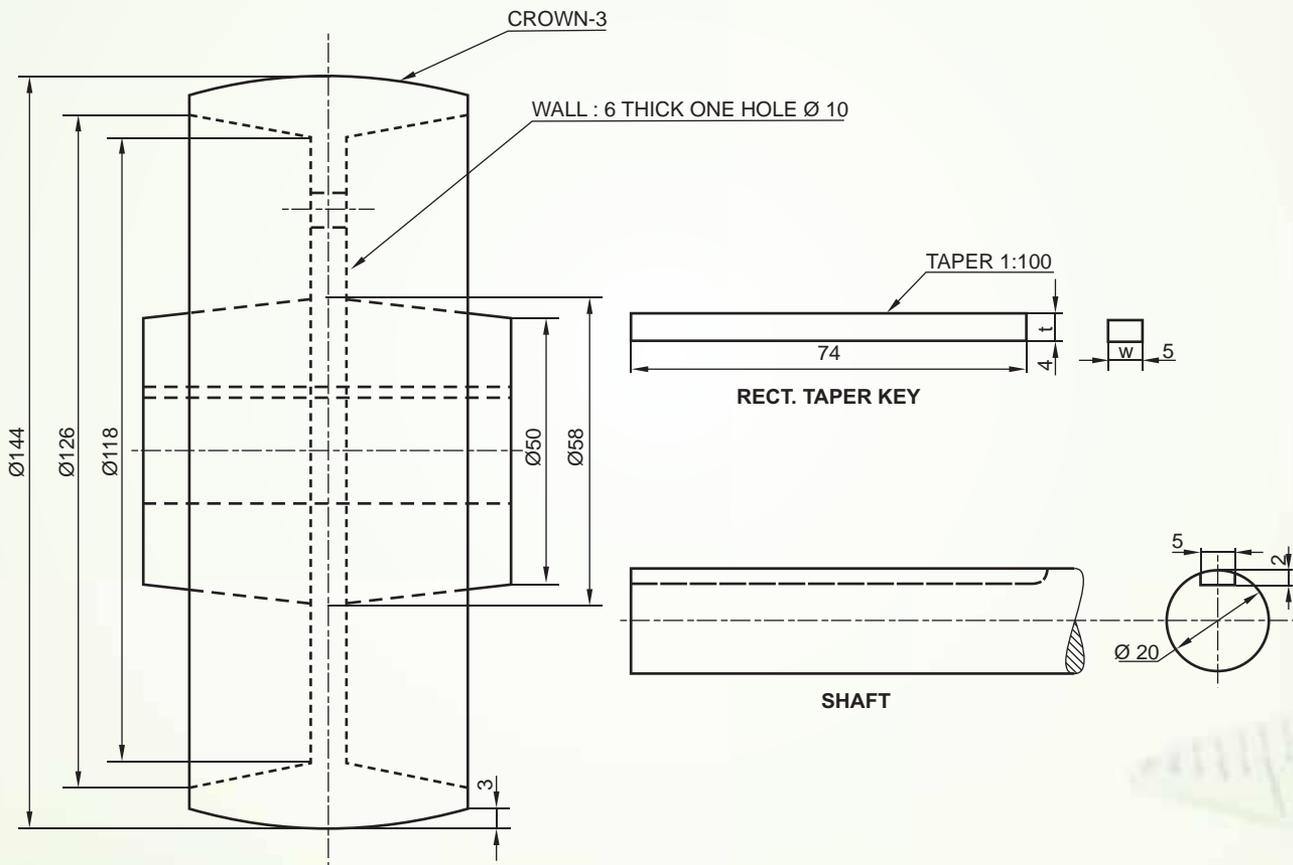
DETAILS OF A SOLID CAST IRON PULLEY
