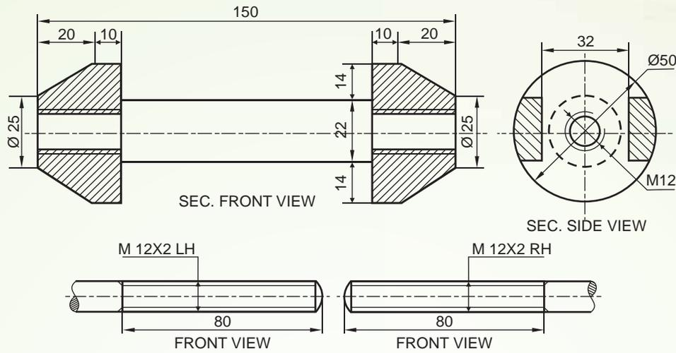
**DETAILS OF A TURNBUCKLE**
