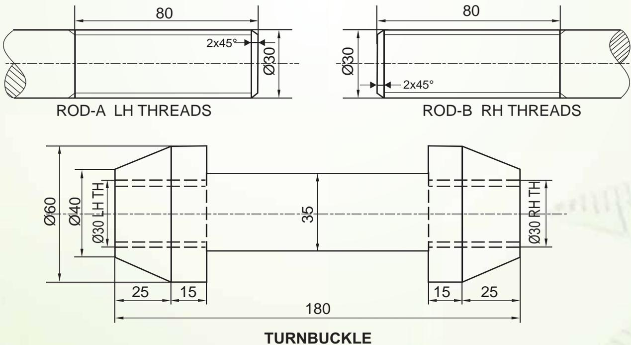
**DETAILS OF A TURNBUCKLE**
