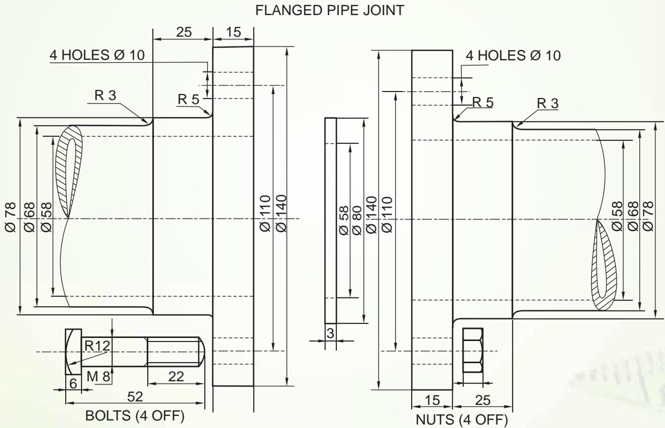
**DETAILS OF A FLANGED PIPE JOINT**
