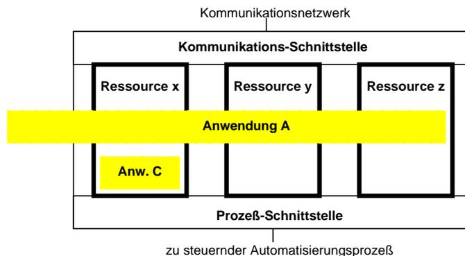
**Abb. 9.2.** Ein Gerät kann mehrere Ressourcen enthalten, die über gemeinsame Schnittstellen Information mit anderen Automatisierungs-Einheiten sowie dem Automatisierungsprozeß austauschen.
