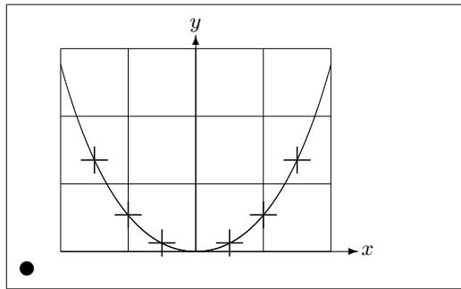
在本图中，悬链线  $y = \cosh x - 1$  对称的两半由二次 Bézier 曲线分别近似地绘成。曲线的右半部分终止于点  $(2, 2.7622)$ ，对应的斜率为  $m = 3.6269$ 。再次使用公式(5.1)，我们可以计算中间控制点。计算结果为  $(1.2384, 0)$  和  $(-1.2384, 0)$ 。图中的十字为真正的悬链线上的点。误差小于百分之一，很难被发现。
