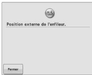
Une autre opération a été exécutée alors que le dispositif d'enfilage automatique effectuait l'enfilage de l'aiguille. Appuyez sur la touche « d'enfilage automatique », puis exécutez l'autre opération après avoir enfilé l'aiguille. (Reportez-vous à la page 51.)
