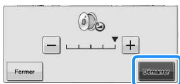
→ La canette commence à enrouler. La canette s'arrête de tourner dès que le bobinage est terminé. La commande de bobinage de canette revient automatiquement à sa position d'origine.
