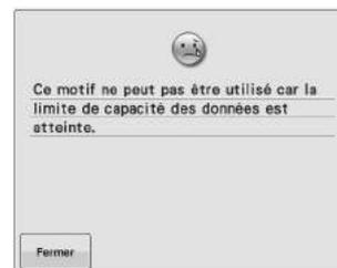
Le motif comporte trop de points et ne peut pas être utilisé. Il est impossible d'afficher les données dont les points dépassent les spécifications (500 000 points). Utilisez le logiciel de conception de données pour réduire le nombre de points.
