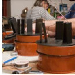
Coloque la placa de fondo en el enchufe y lo puso a un anillo (3 cm de ancho, cortado de un tubo) como separador y el siguiente plato sobre ella. Desconecte el terminal positivo de la bobina inferior y los cables de cobre recubiertos libremente a través de los recortes con después oben. Quelle: [www.Plasma-Energie.org](http://www.Plasma-Energie.org)
