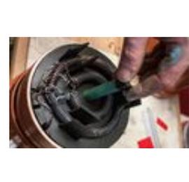
Deslizar los tubos de ganso suavemente a través de los agujeros en las placas individuales por centrar y esto entre las tres bobinas. Fuente: [www.Plasma-Energie.org](http://www.Plasma-Energie.org)
