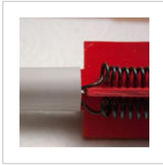
Combinación de condensadores 4p colocado en la vivienda. Fuente: [www.Plasma-Energie.org](http://www.Plasma-Energie.org)
