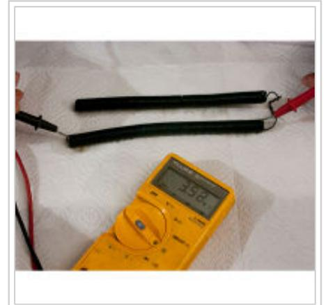
La polarización de una bobina con el multímetro, establece en ohmios Fuente: [www.Plasma-Energie.org](http://www.Plasma-Energie.org)
