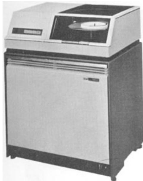
**Figure 9 IBM 2311 Disk Storage Unit**
