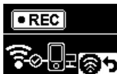
Si la connexion Wi-Fi est coupée pendant l'enregistrement, la caméra continue d'enregistrer et entre dans l'interface d'enregistrement sans connexion.
