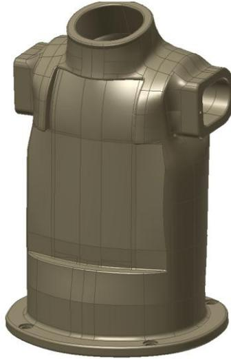
FIGURE 7 - 3D SHAPE OF INSIDE JACKET MANDREL
