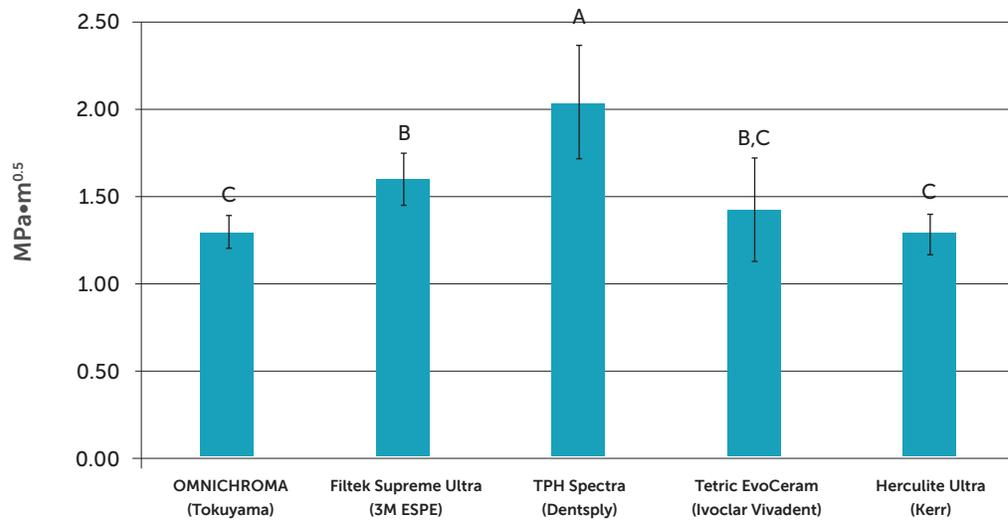
Fig. 36 Fracture toughness
