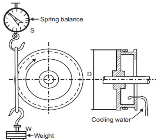
**Fig. 30. Rope brake**
