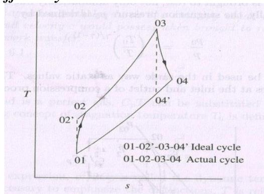
**Fig. 50. T-S diagram of actual cycle**
