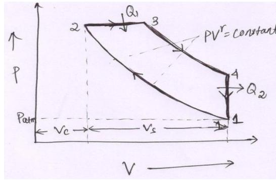
**Fig. 8. Diesel cycle**
