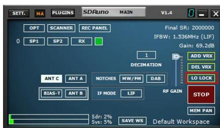
La modification du matériel LO a pour effet de modifier la fréquence de réglage de tous les VRX actifs. Cela se produit lorsque vous modifiez la fréquence de réglage de VRX #0 (le maître RX). Si vous souhaitez modifier la fréquence des #0 VRX sans modifier le matériel LO, vous pouvez utiliser le bouton LO LOCK dans le panneau principal. Mais si vous n'avez besoin que d'un verrou temporaire, appuyez simplement sur la touche SHIFT lors de l'accordage.
