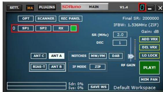
SDRuno peut créer et exécuter plusieurs VRX à l'intérieur de la même instance d'application. Lorsque vous exécutez une instance de SDRplay, un seul VRX est toujours créé : il s'agit du #0 VRX ou VRX « maître ». VRX #0 a quelques particularités :
