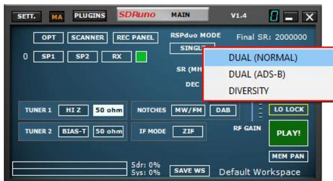
DUAL (NORMAL) - Sélectionnez ce mode à moins que vous n'aient l'intention d'exécuter ADS-B à l'aide du Tuner esclave
