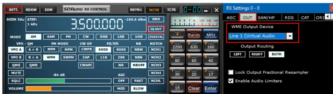
Le mode IQ OUT est un mode spécial dans lequel le signal I/Q filtré sélectionné par le VFO est acheminé directement vers la sortie audio en contournant la fonction de démodulation.
