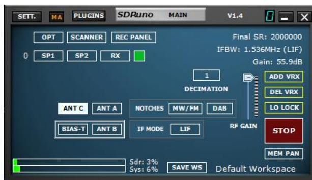
Différents boutons RSP apparaîtront en fonction du récepteur contrôlé par cette instance de SDRuno (l'image ci-dessus utilise le RSPdx). Ceux-ci peuvent être vus à la section [3.3](#)
