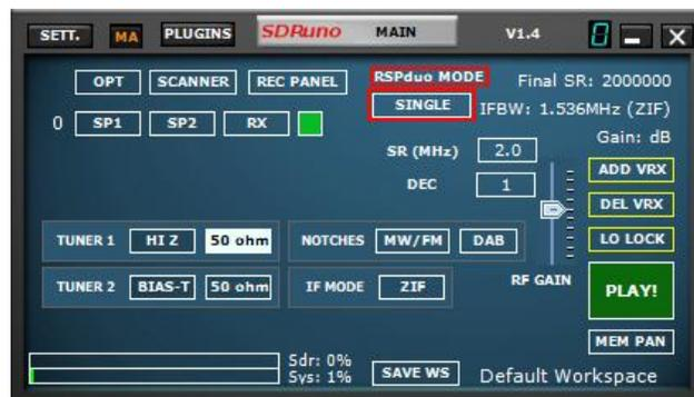
Lors de l'utilisation du RSPduo, le Panneau principal indique le mode de fonctionnement de l'appareil.
