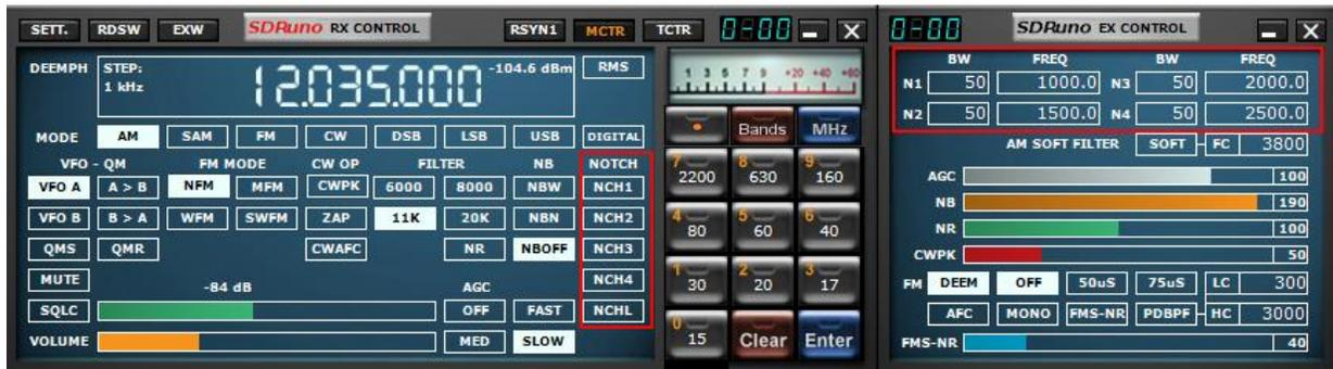
Chaque VRX offre quatre filtres notch pour supprimer les signaux indésirables, placés avant l'AGC audio. Chaque filtre notch peut-être activé/désactivé par le bouton pertinent du panneau de configuration RX. Les paramètres de bande passante et de fréquence des filtres d'encoche sont disponibles dans le panneau de configuration RX EX.
