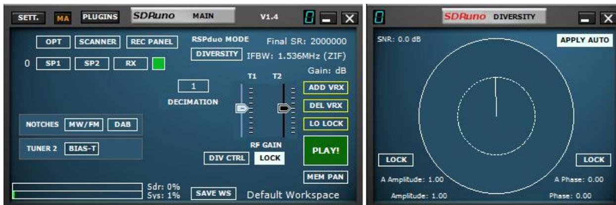
À partir de V1.32, MRC (Rapport maximal Combinant) Diversity est pris en charge à l'aide du RSPduo. MRC Diversity peut être utilisé pour combiner les deux flux d'entrée tuner ensemble pour améliorer potentiellement le SNR (rapport signal/bruit). La même fréquence est utilisée pour les deux accordeurs dans le RSPduo et le gain peut être ajusté soit sur chaque accordeur indépendamment ou verrouillé ensemble (la méthode par défaut).
