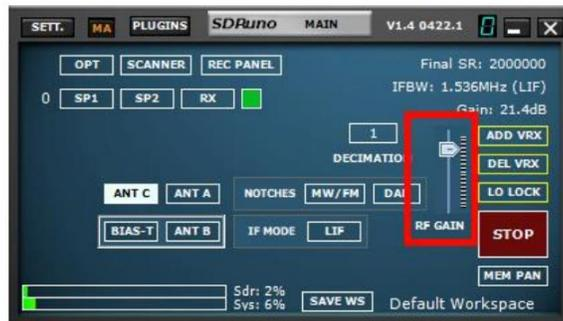
Le curseur RF GAIN doit être placé au maximum ou au maximum, à moins qu'un message d'avertissement OVERLOAD ne s'affiche. Si un message OVERLOAD s'affiche, abaissez le curseur RF GAIN jusqu'à ce que le message OVERLOAD ne s'affiche plus.
