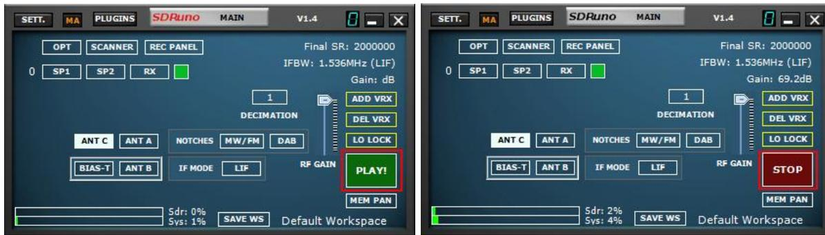
Démarrage du RSP dans SDRuno est en cliquant sur le bouton PLAY vert affiché dans le panneau MAIN. Le bouton PLAY deviendra rouge et réétiqueté pour STOP. En cliquant sur le bouton STOP, le flux SDRuno. En cliquant en haut à droite, X ferme l'application SDRuno. SDRuno peut également démarrer automatiquement le flux en sélectionnant « Démarrage automatique activé » dans les paramètres OPT du panneau MAIN.
