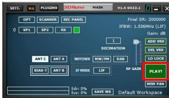
En cliquant sur le bouton PLAY du panneau MAIN, le flux de données démarre (mise sous tension).
