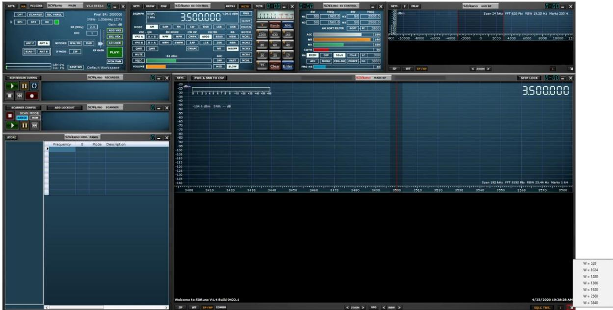
Le SP principal peut être redimensionné librement, ou une largeur de résolution prédéfinie peut être sélectionnée en cliquant avec le bouton droit sur la flèche dans le coin inférieur droit du SP principal.
