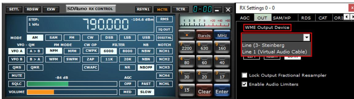
Chaque VRX peut avoir son dispositif de sortie WME. Plus vrX peut partager le même appareil WME. Le périphérique de sortie peut être sélectionné dans rx control->Settings->Out Tab. Si aucun périphérique n'est sélectionné (par défaut), le VRX utilisera la valeur par défaut du système (maple sonore). SDRuno doit disposer d'un périphérique de sortie. Pour plus de détails sur les récepteurs virtuels (VRX), veuillez consulter la section [4.12](#)
