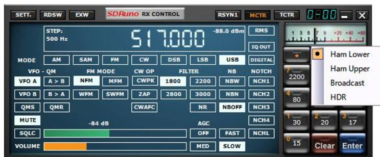
En cliquant à gauche ou à droite sur le bouton « Bandes », les pré-réglages supplémentaires du segment de bande.
