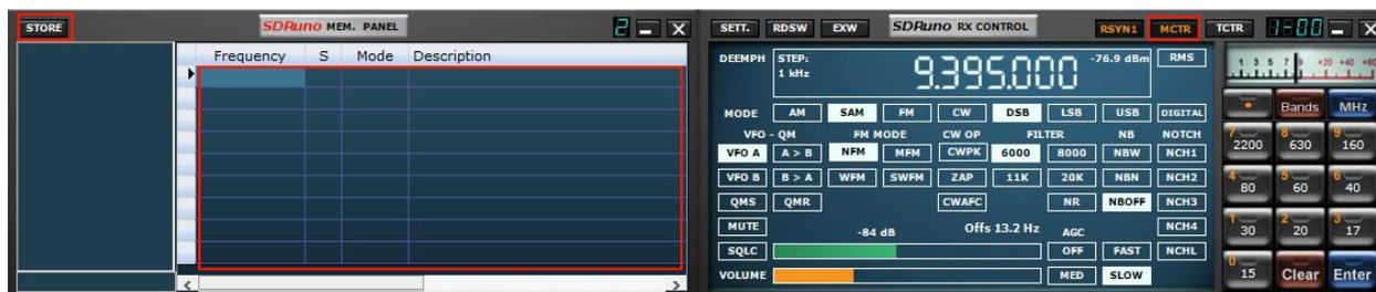
Lors du stockage vers un nouvel emplacement de mémoire, SDRuno insère d'abord une nouvelle ligne vide après celle en cours, remplissant certains champs automatiquement et faisant finalement de cette ligne la ligne actuelle en préparation pour la prochaine opération. Le programme remplit les champs Fréquence, Mode, Sous mode et Filtre avec des données d'un VRX spécifique. Il existe différentes méthodes pour effectuer l'opération ci-dessus :
