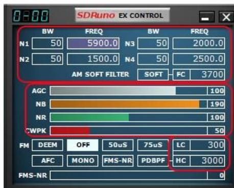
Ces contrôles sont facilement reconnaissables que leur arrière-plan se tournent vers le violet que vous placez le curseur au-dessus d'eux ; quelques exemples sont les filtres encoche BW et Freq. Contrôles dans le panneau « RX EX Control »
