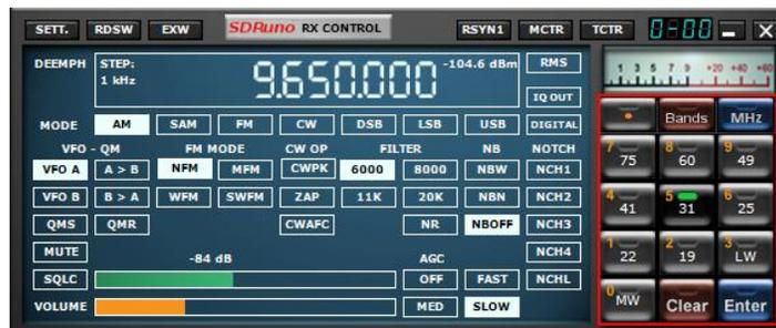
Lorsque vous appuyez sur l'un des boutons de ramage de la bande f dans le panneau RX CONTROL, le bouton de bande sélectionné s'allume en vert en activant les éléments suivants : verrouillage de LO, réglage automatique du taux d'échantillonnage et valeur de décimation ainsi que le mode RX correct pour la bande sélectionnée. Le panneau MAIN SP va maintenant « encadrer » la plage de fréquences complète de la bande choisie.
