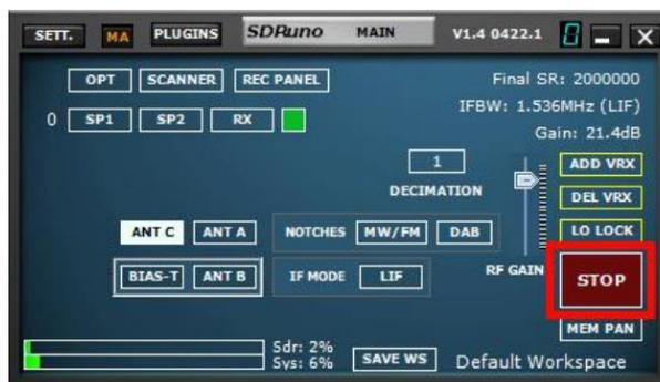
En cliquant sur le bouton STOP du panneau MAIN, le flux de données (mise sous tension).
