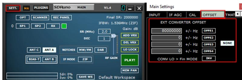
Jusqu'à quatre décalages de convertisseur peuvent être stockés dans chaque instance de SDRUno. Les paramètres de décalage sont disponibles dans le panneau principal ->Sett.->OFFSET.
