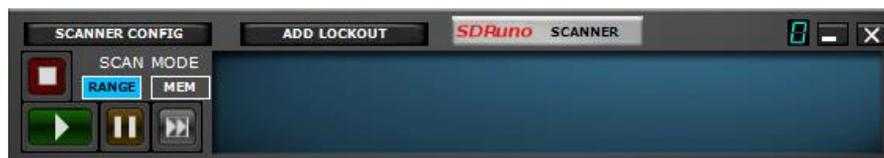
La mise en conserve de SDRUno comporte deux modes. Il peut soit scanner une liste de fréquences qui existent déjà dans le panneau de mémoire ou il peut effectuer un « scan aveugle » d'une région de spectre avec une taille d'étape définie et soit s'arrêter quand il trouve un signal et rester sur le signal aussi longtemps que le signal est présent ou rester sur le signal pour une période de temps définie par l'utilisateur.
