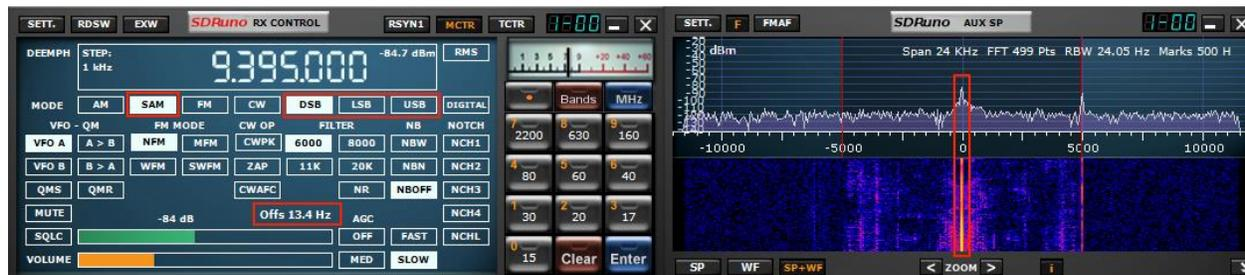
SDRuno implémente un mode SAM (Synchrone AM) haute performance. Lorsque vous sélectionnez SAM, le dernier sous-mode utilisé est également rappelé (LSB, USB ou DSB). Une fois que SAM est engagé, vous pouvez passer au sous-mode souhaité en cliquant sur les boutons relatifs :
