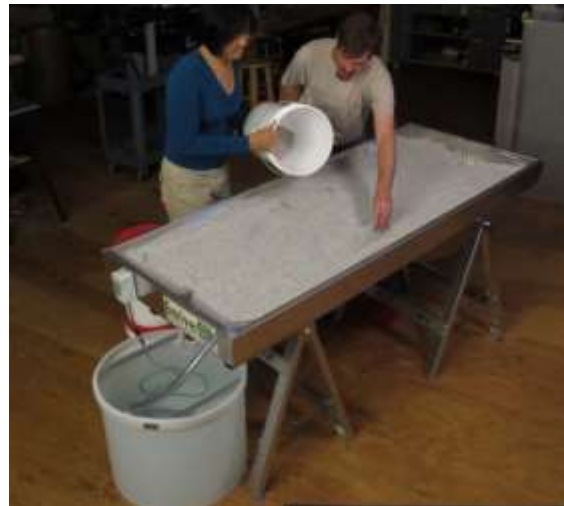
Figure 16. Pour the media into the box
