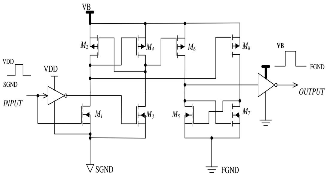
Figure 4.7 2<sup>nd</sup> level shifter
