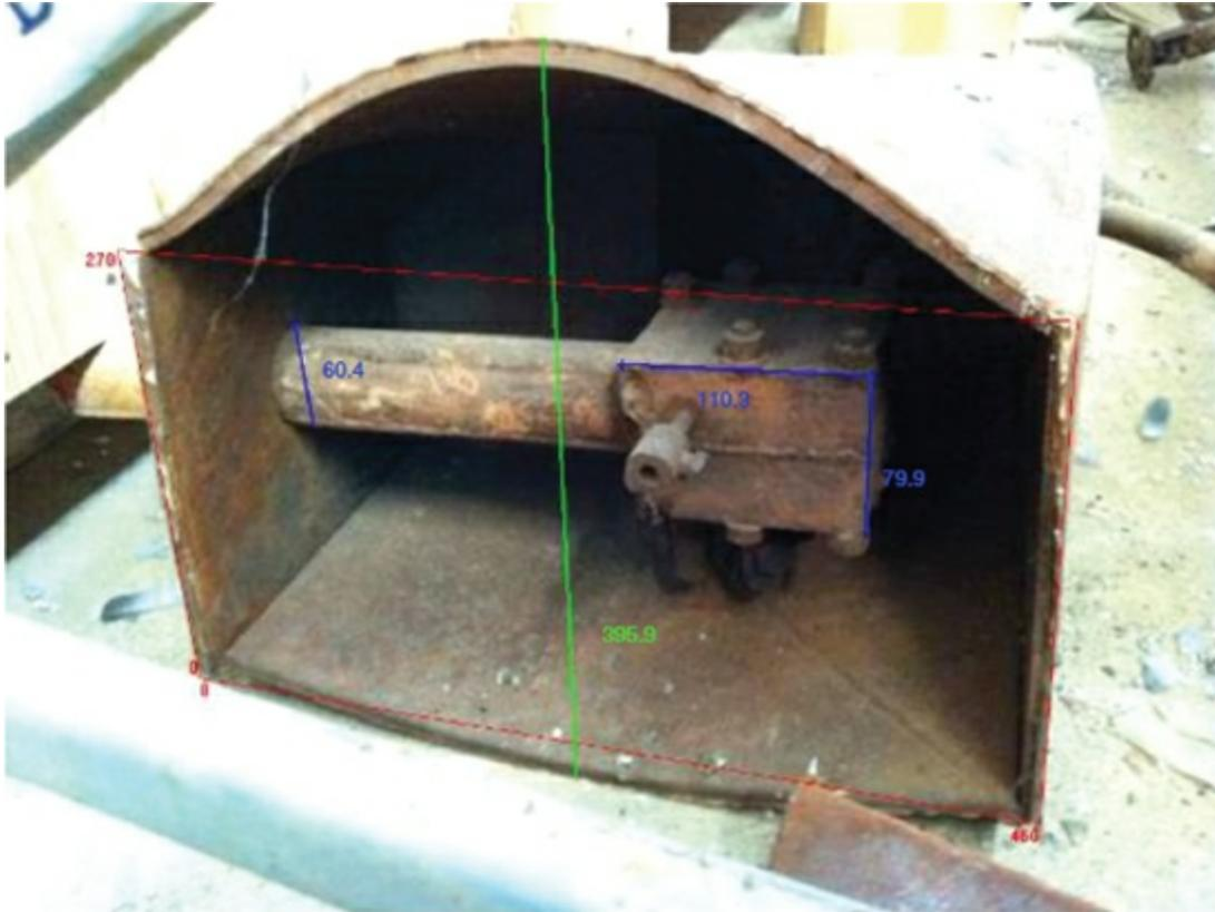
[Figure 7.7.1](#) Ruptured steel box.
